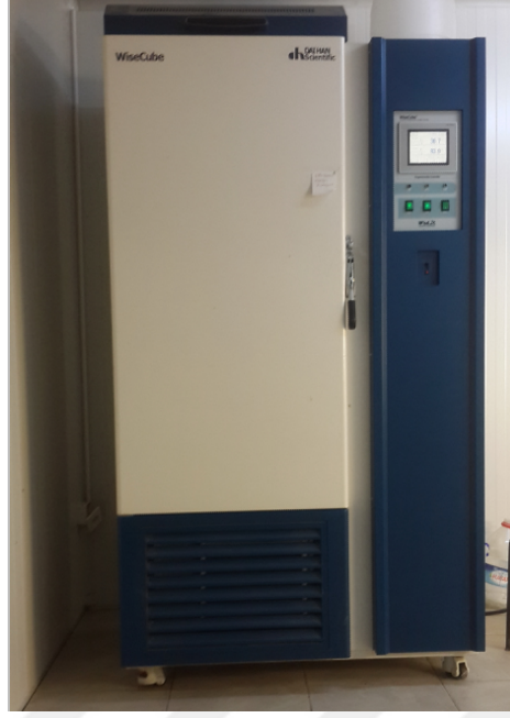
Şekil 3.10. Peletlerin nem alma dirençlerinin tespit edilmesinde kullanılan iklimlendirme kabini
