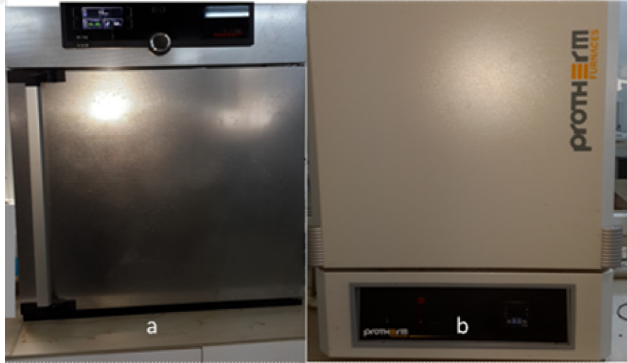
Şekil 3.5. Denemelerde kullanılan etüv (a) ve kül fırını (b)
