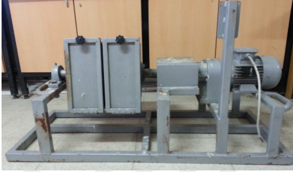
řekil 3.6. Düşme dayanıklılık test cihazı
