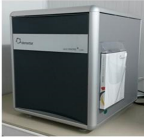
Şekil 3.9. Karbon ve azot tayininin gerçekleştirildiği analiz cihazı
