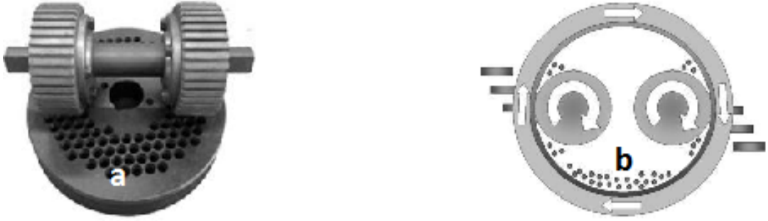
Şekil 2.1. Düz kalıplı (a) ve çember kalıplı (b) peletleme teknolojisi
