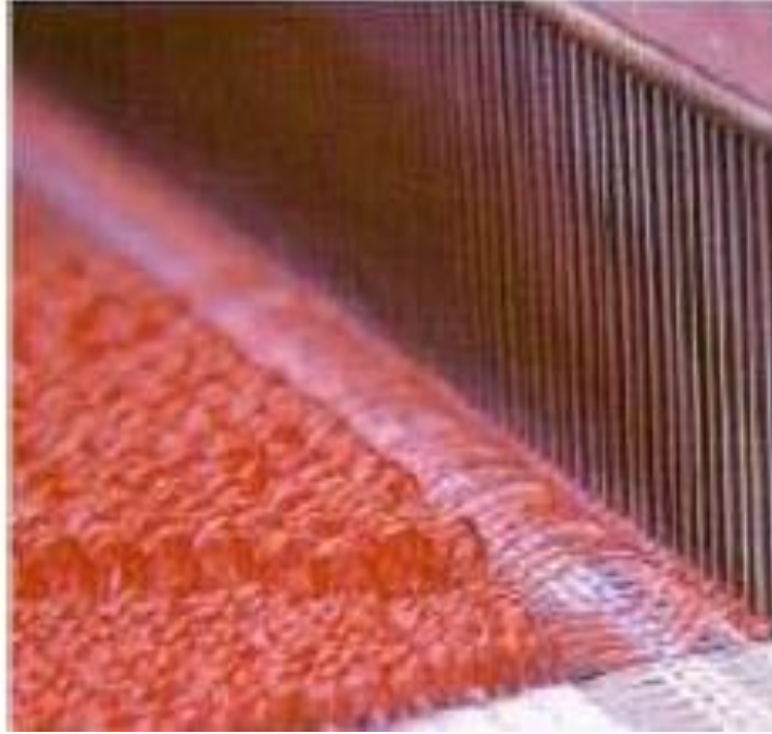
Şekil 1.16. Farklı hav yüksekliğine sahip havlu yapısı (Zervent, 2007)
