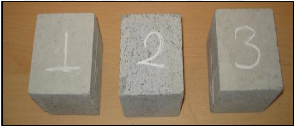
Şekil 4.67. Görünür yoğunluk ve basınç dayanımı tayini için kullanılan tefri-fonolit numunesi
