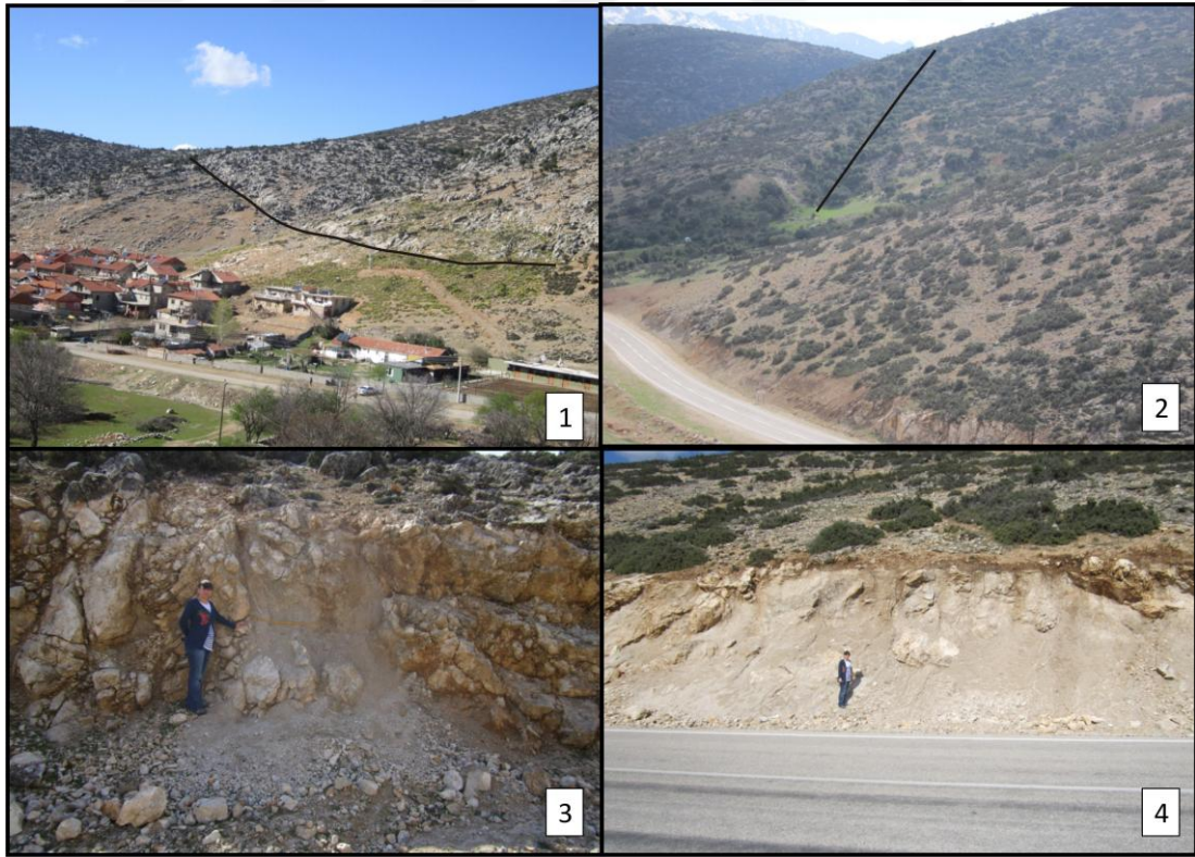
Şekil 4.40. Büyükhacılar köyünün kuzeydoğusunda kalan fay (1), çalışma alanındaki fayın sunduğu çizgisel yapılar (2), Kaplangılı tepenin güneydoğusundan geçen faylara ait ezik zonlar ve çizgisel yapılar
