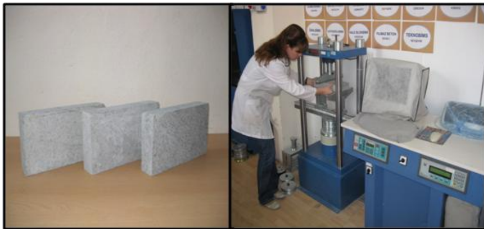
Şekil 4.70. Eğilme dayanımı için tefri-fonolit prizmatik örnekler ve eğilme dayanımı deneyi ve deney cihazı
