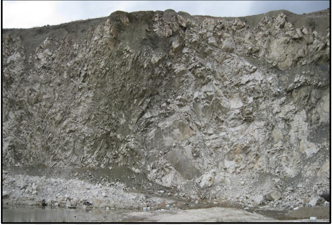
Şekil 4.20. Isparta ofiyolit karmaşığı içerisinde bulunan bol kırıklı çatlaklı masif Domuzdağı kireçtaşı ait bir görünüm
