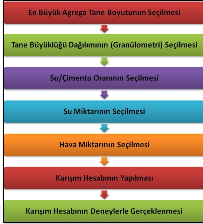
Şekil 3.2. TS 802 (2009)'ye göre beton karışım hazırlama akım şeması
