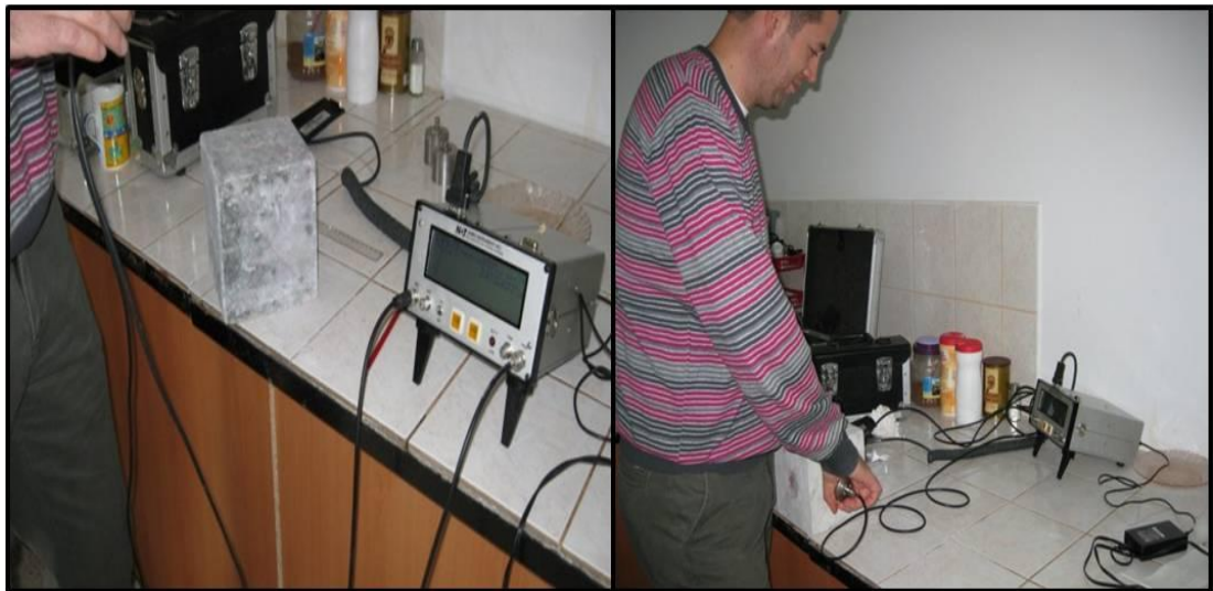
Şekil 4.120. Ultrasonik test aygıtıyla beton numunelerinin ultrases hızlarının ölçülmesi
