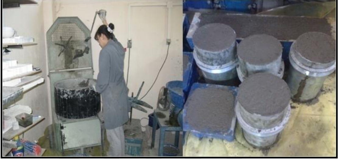
Şekil 4.104. Taze betonun mikserde karıştırılması ve kalıplara yerleştirilmiş taze beton
