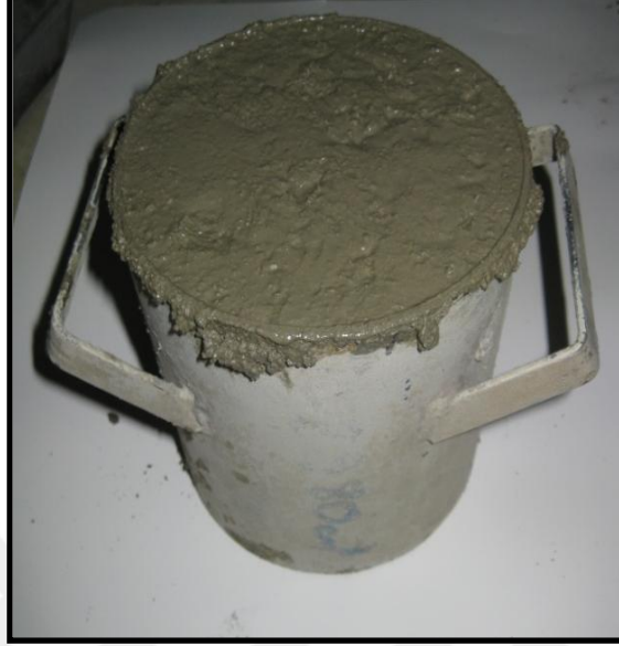
Şekil 4.105. Taze betonun yoğunluğunun belirlenmesi
