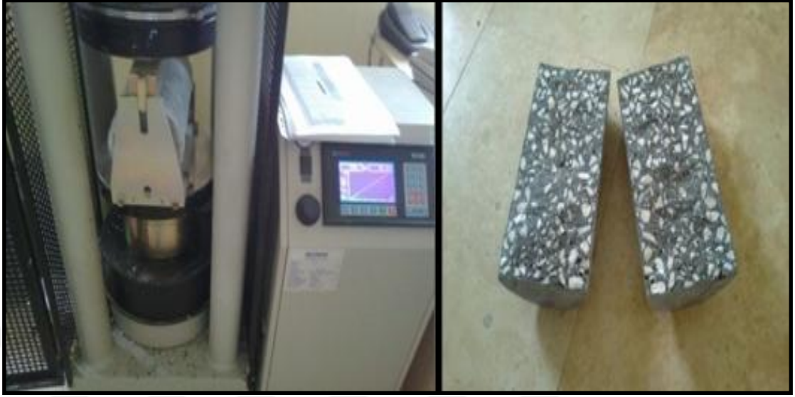
Şekil 4.117. Yarmada-çekme deneyi ve beton örneği yarmada çekme deneyi sonrası
