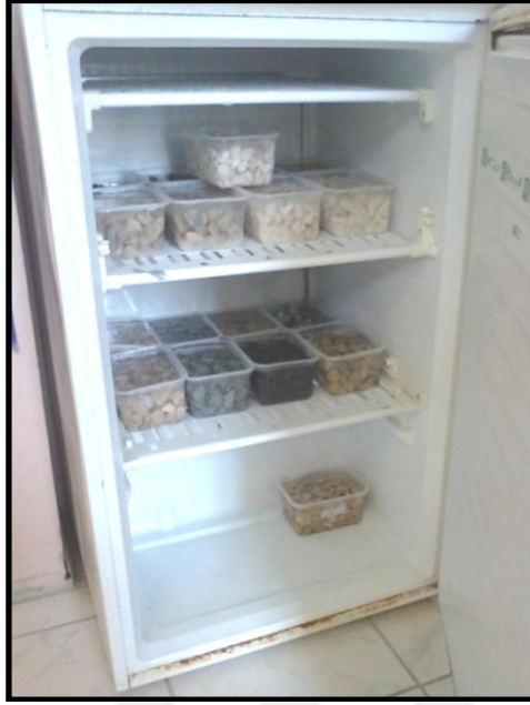
Şekil 4.94. Agregaların donma-çözülme karşı direcinin tayini
