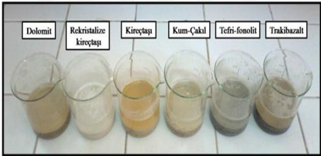
Şekil 4.86. NaOH çözeltisinde 24 saat bekletilen agregalar
