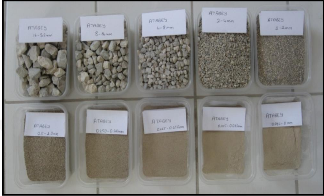
Şekil 4.73. Elek analizi sonrası boyutlandırılmış agregalar
