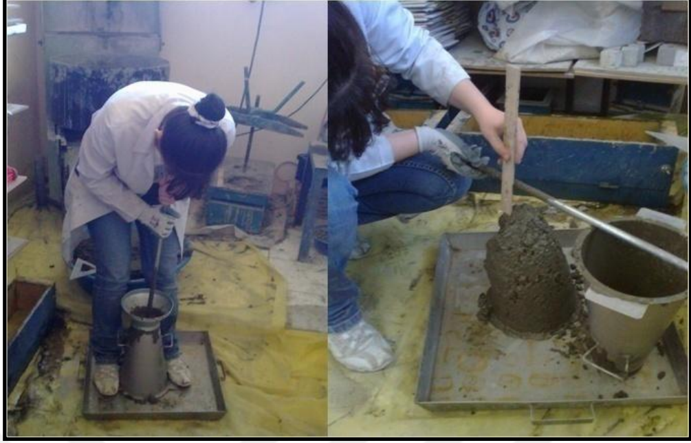
Şekil 4.106.Taze betonda çökme miktarının ölçülmesi
