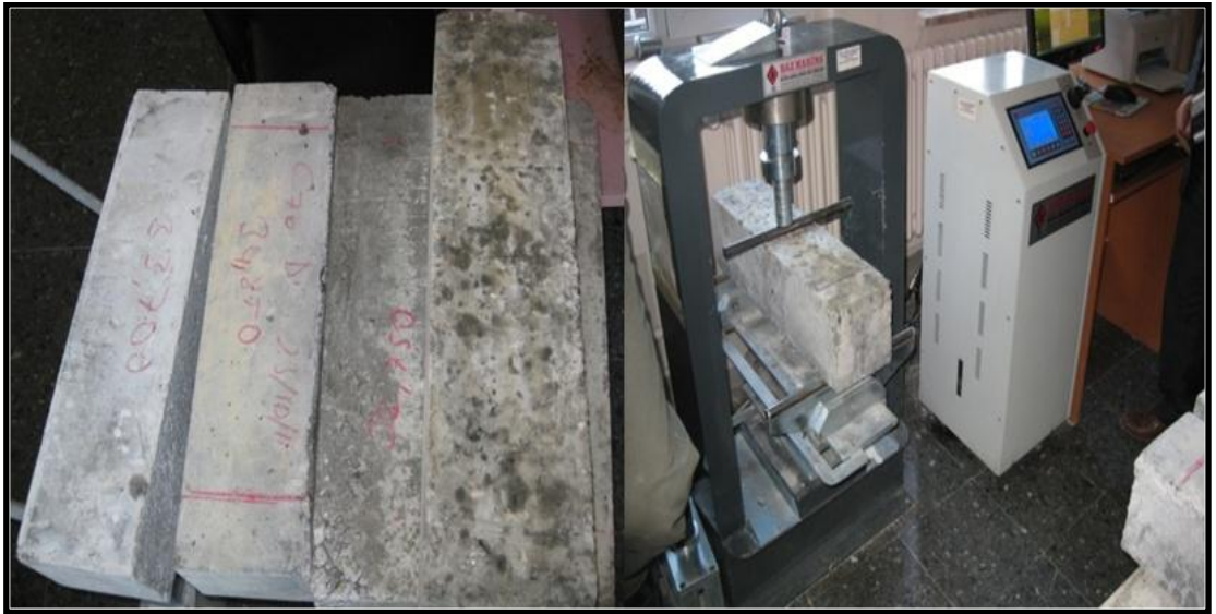
Şekil 4.114. 150*150*600 mm boyutundaki prizma beton örnekleri ve beton örneklerinin eğilme dayanımı tayini
