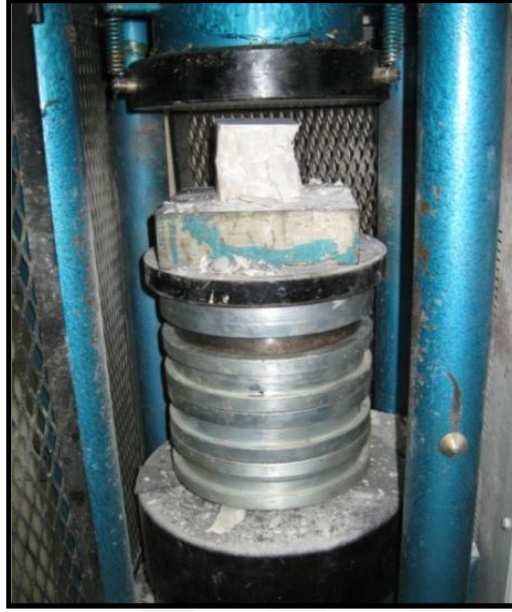
Şekil 4.65. Tefri-fonolit kayacının basınç dayanımı testi
