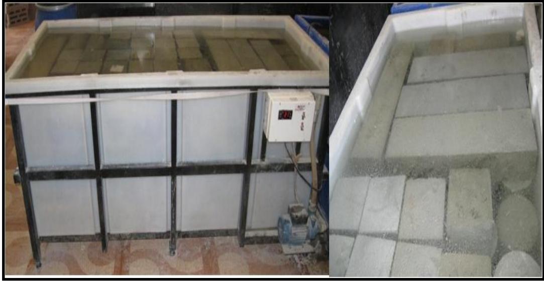
Şekil 4.107. Sertleşmiş beton küre
