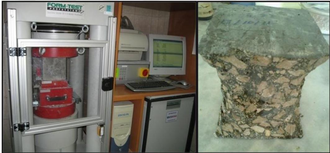
Şekil 4.108. Basınç dayanım testi ve basınç deneyi sonrası beton numunesi
