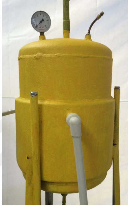
Şekil 3.23. Deneysel düzenekte kullanılan kondanser
