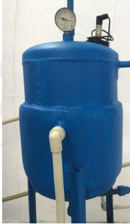
Şekil 3.22. Deneysel düzenekte kullanılan evaporatör
