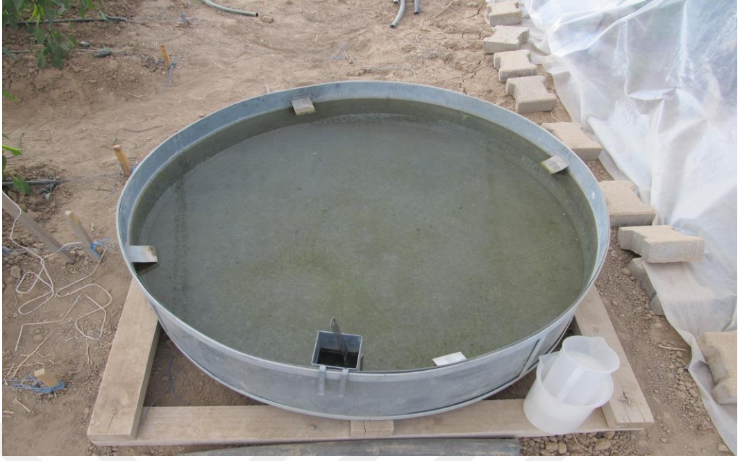
Şekil 3.6. Sera içerisine yerleştirilen A sınıfı buharlaşma kabı
