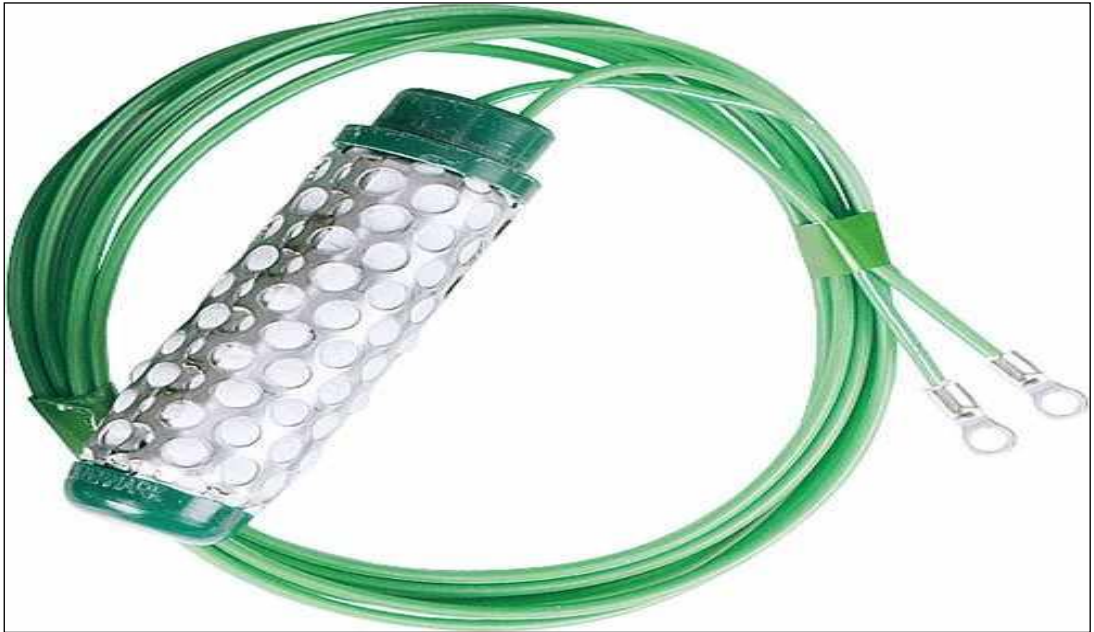
Şekil 3.7. Denemede kullanılan Watermark cihazı
