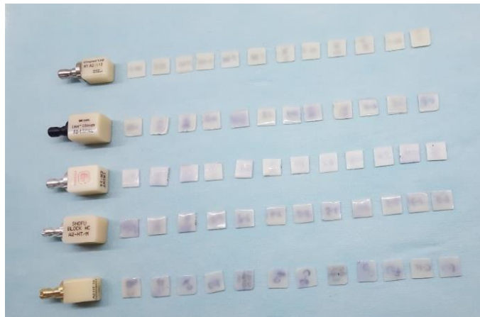
Resim-2: Dijital kumpas yardımıyla boyutları ölçülerek seçilen standart numuneler
