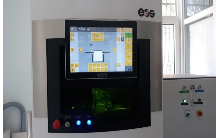
Resim 8. Direkt lazer metal sinterizasyon teknolojisi ile 3D üretim cihazında alt yapı üretimi
