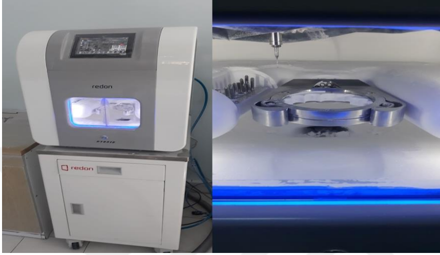
Resim 14 PEEK bloklardan alt yapı üretimi
