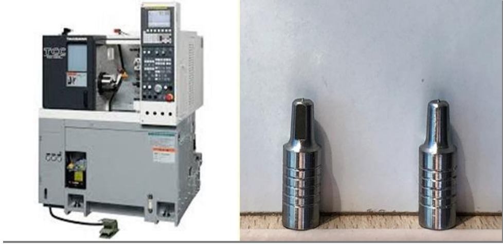
Resim 2. Paslanmaz çelik güdüklerin üretimi CNC tezgâhı (Takisawa Machine ToolCo., Ltd. JAPONYA)
