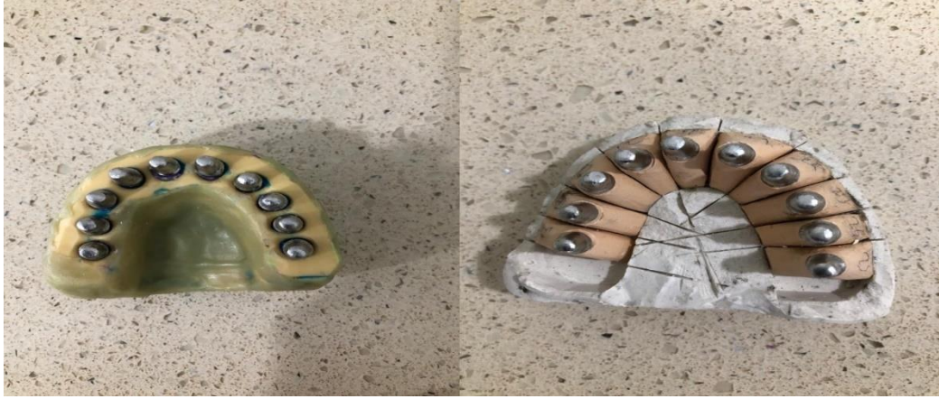
Resim 9. Direkt lazer metal sinterizasyon teknolojisi ile 3D yazım cihazında üretilen alt yapılar
