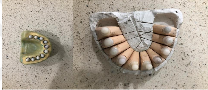
Resim 12. Y-TZP zirkonyum oksit bloklardan elde edilen zirkonya alt yapılar
