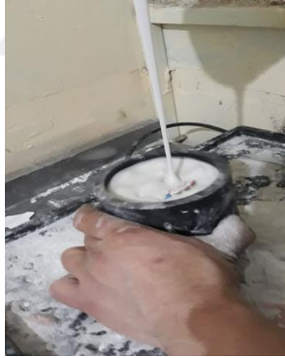
Resim 5. Akışkan kıvamdaki revetmanın manşet içine doldurulması
