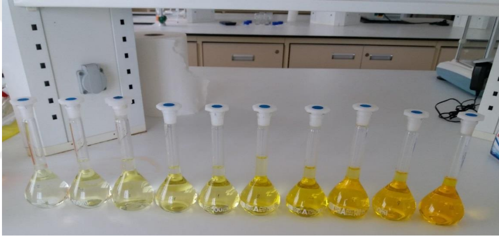
Şekil 3.7. MGY 400 için kalibrasyon eğrisi belirleme çalışması
