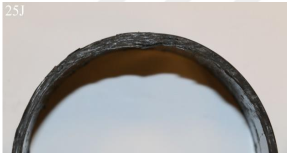
Şekil 37.KNT Takviyesiz Boru Et Kalınlığındaki Hasar Mekanizmaları
