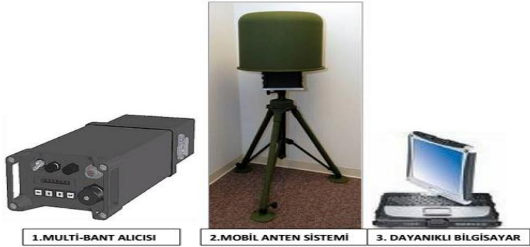
Şekil 3.10: İnsansız Araçların Mobil Kontrol Cihazları; 1. Multi-Bant Alıcısı, 2. Mobil Anten Sistemi, 3. Dayanıkl Bilgisayar.
