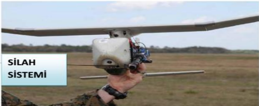
Şekil 5.38: Silah Sistemi Monte Edilmiş Mini İHA.
