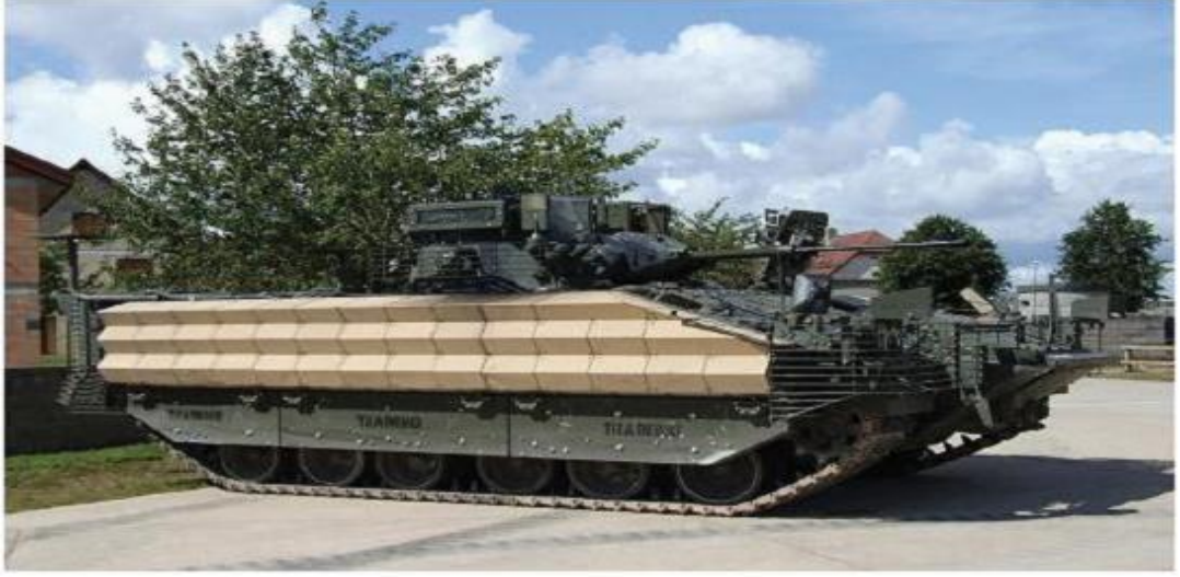
Şekil 5.24: Zırhlı Piyade Aracına Monte Edilen Süper Hafif Zırh.
