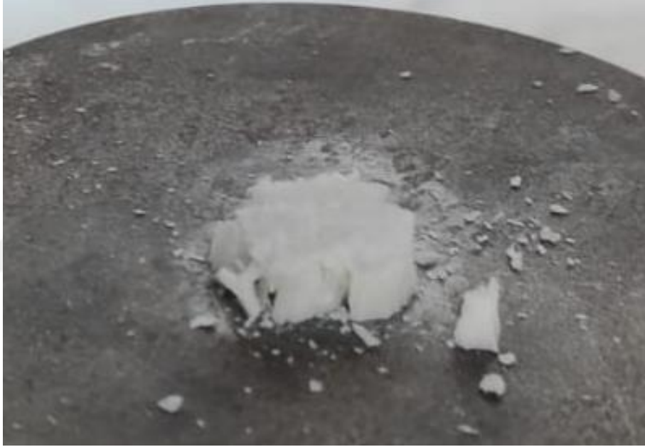
Şekil 5.8 Basma Testinde Deplasman Olarak Fazla İlerleyen Bir Numunenin Görünüşü
