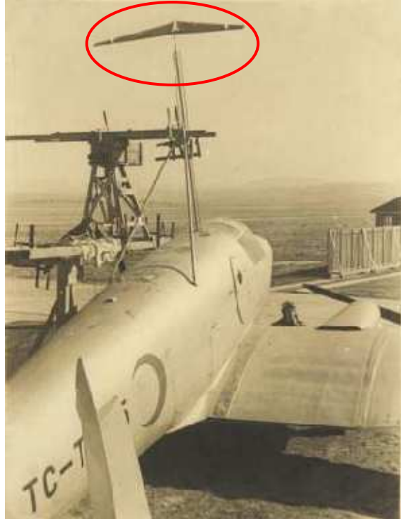
Şekil 4.32.: THK-13 Uçan Kanat Planörünün THK-5'in Sırtına Sabitlenmesi
