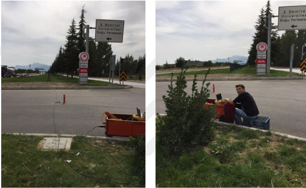
Şekil 3.10. ReMi verisi alınırken arazi ve ekipman görüntüsü
