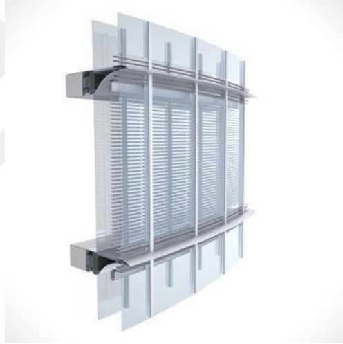
Şekil 2.10. Çift tabakalı cephe sistemi perspektif gösterimi (Web İletisi 8).
