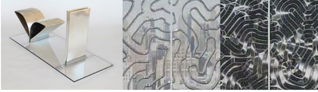
Şekil 4.44. dielektrik elastomerin açık ve kapalı hali ve cephe de görünümü (Web iletisi 41)
