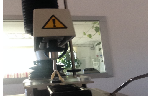
Şekil 3.2. Hamurun Kieffer düzeneğinde uzatılması
