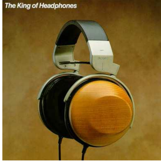
Şekil 2. 17. Sony tarafından üretilen, bakteriyel selüloz diyaframının kullanıldığı kulaklık
