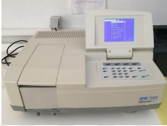
Şekil 3. 2. UV spektrofotometre ile mikroorganizma yoğunluğu ölçümü
