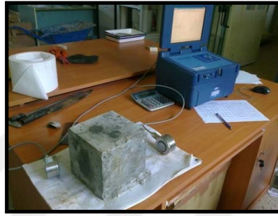
Şekil 3.16. Ultrasonik sismik P ve S dalga ölçüm cihazı
