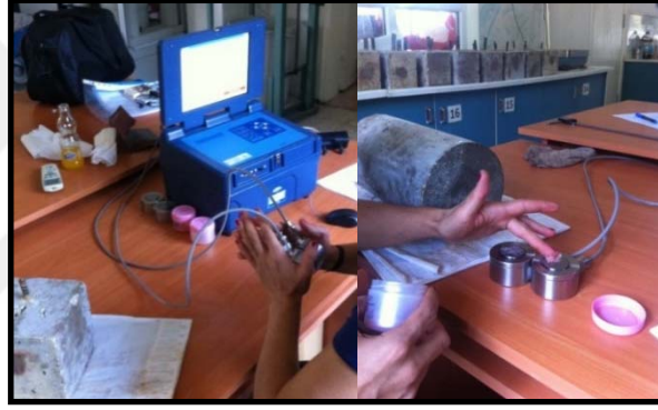
Şekil 3.14. Ultrasonik sismik yöntem ile sıfır ayarı ve problara jel sürülmesi (P dalga ölçümü için).
