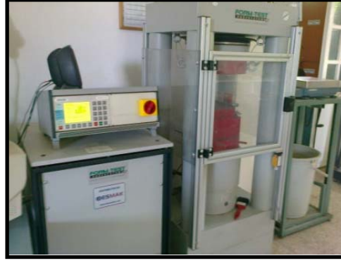
Şekil 3.21. Tek eksenli basınç deneyi cihazı
