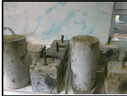
Şekil 3.4. Silindir ve küp şeklindeki beton numuneler
