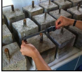
Őekil 3.8. Sayısal kumpas ile numunelerin boyutlarının belirlenmesi
