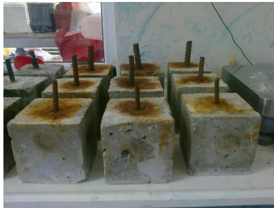
Şekil 3.5. İçerisinde farklı çaplardaki donatı demiri bulunan numuneler
