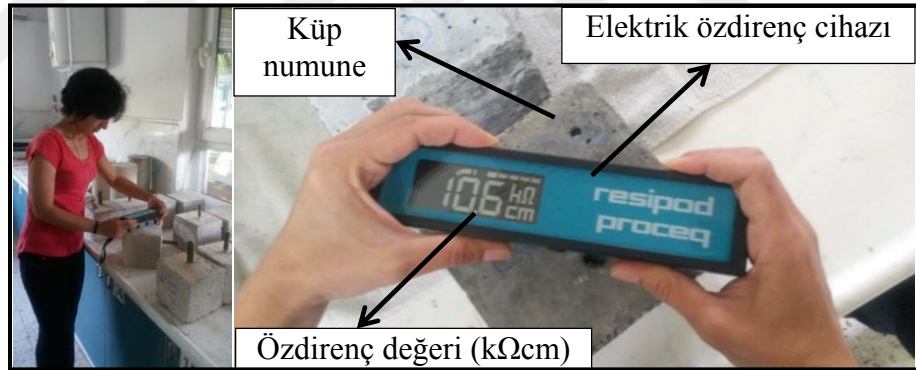
Şekil 3.20. Özdirenç cihazı ve ölçüm alımı
