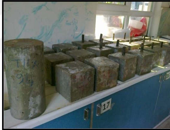
Şekil 3.1. Donatılı ve donatısız beton numuneleri
