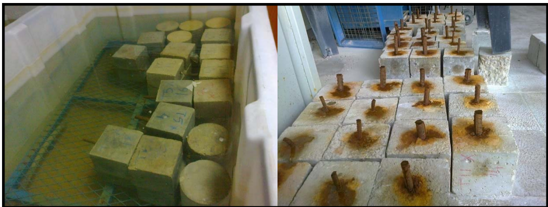
Şekil 3.2. Su kürüne ve hava kürüne tabi tutulan numuneler
