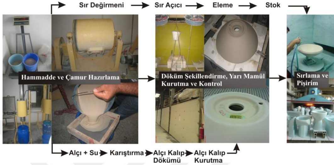
Şekil 2.7. Sağlık gereçleri üretiminde izlenen aşamalar (Haner ve Haner, 2014)
