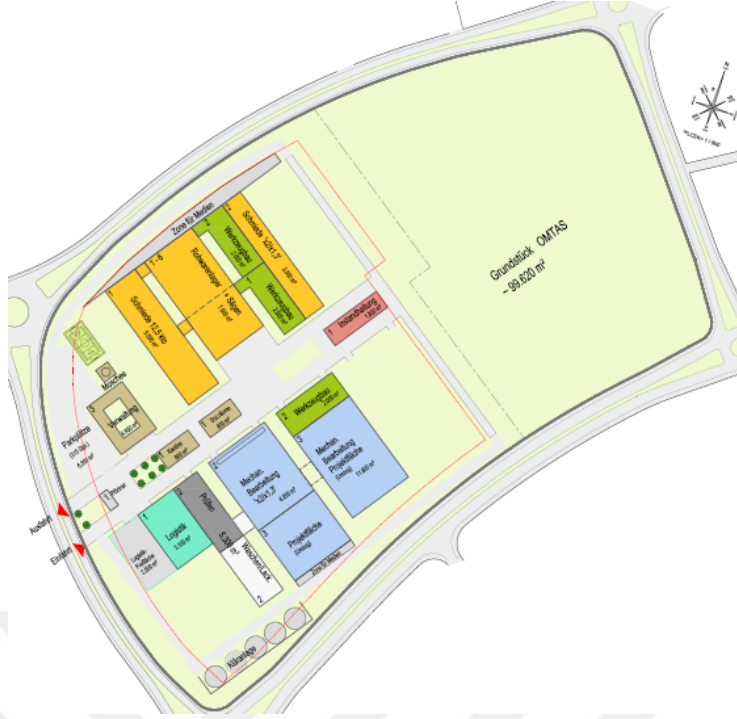
Şekil 3.5.1: Yeni tesisin yerleşim alternatifi – Kare modüler (U tip)
