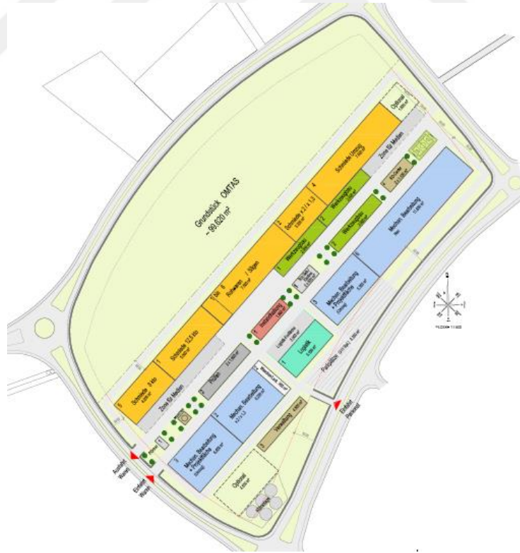
Şekil 3.5.2: Yeni tesisin yerleşim alternatifi – Lineer modüler (I tip)
