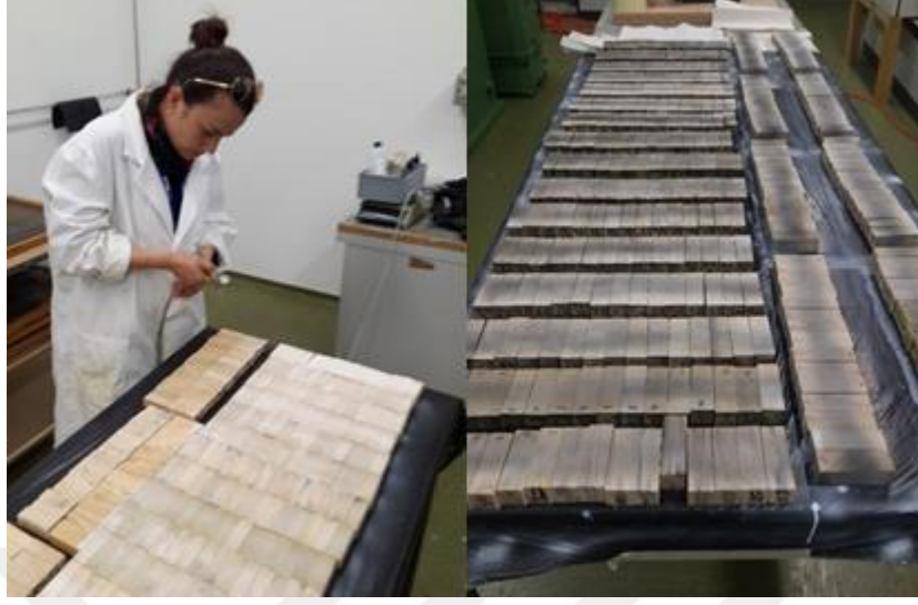
Şekil 3.4. Deney örneklerin boyanması
