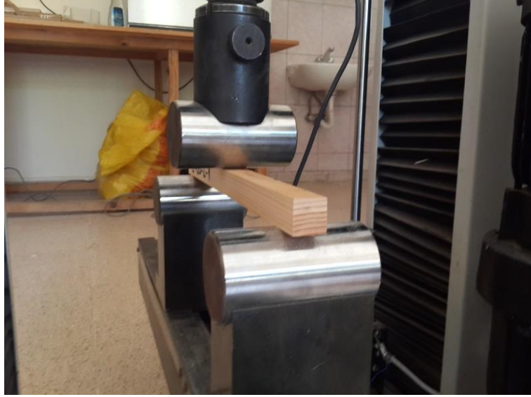
Şekil 3.6. Eğilme deneyi örneği ve test düzeneği
