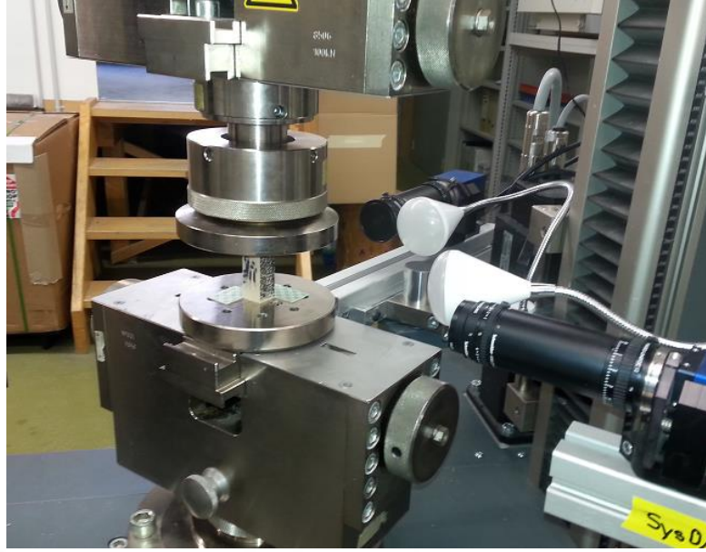
Şekil 3.5. Basma testi deney örneği ve test düzeneği
