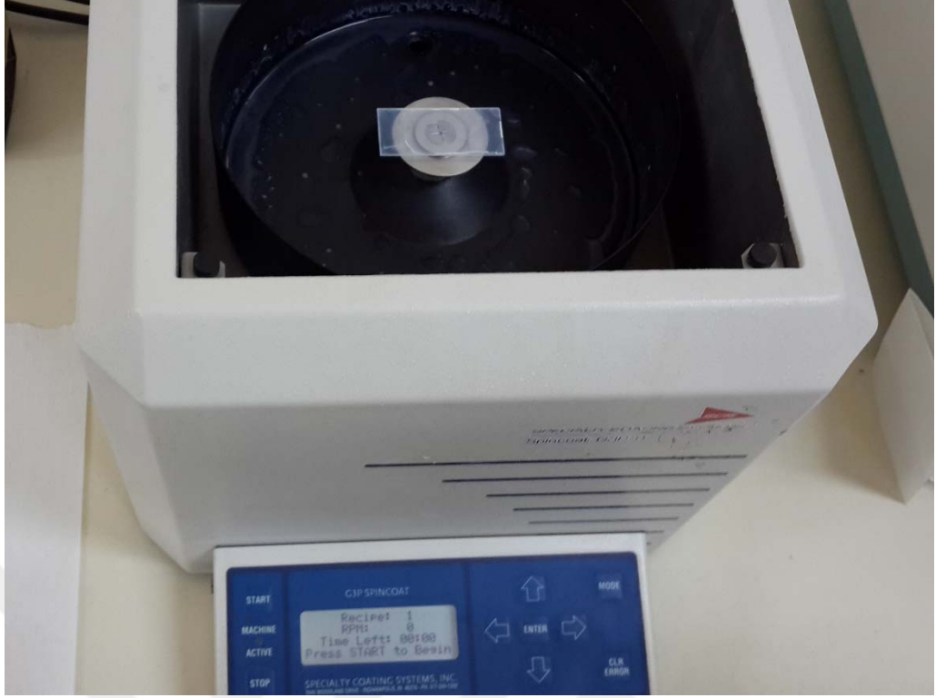
Şekil 4.2. Spin coating cihazında kaplama işlemi
