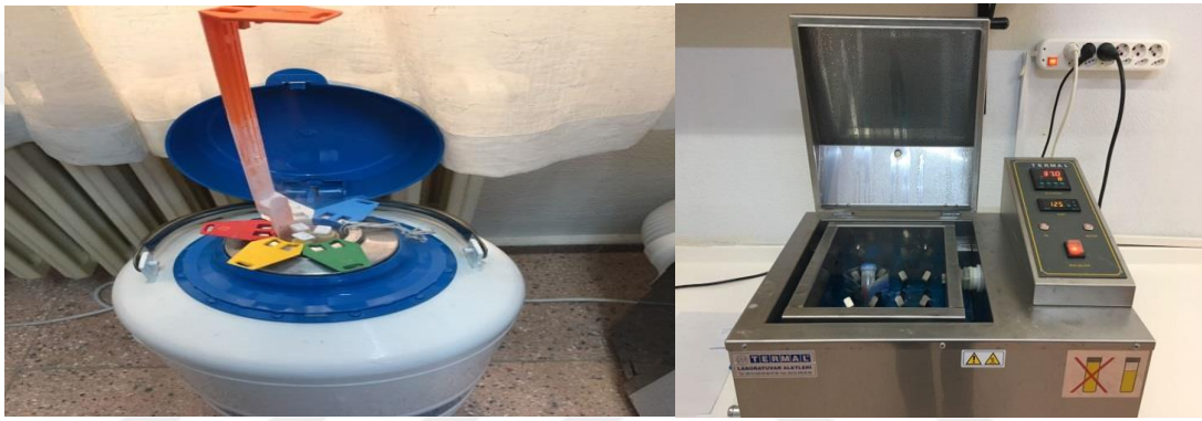
Şekil 6. -196 °C sıvı azot tankı ve çalkalamalı su banyosu
