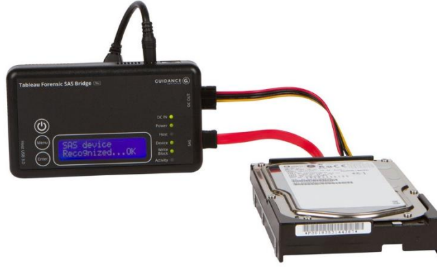
Şekil 3.3.1.1.2: Tableau T6u Yazma Koruma Köprü Kiti SAS Disk Bağlantısı
