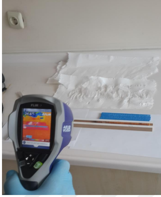
Şekil 3.34. Islatılan artım kalemlerinin termal kamera kullanılarak çekimlerinin yapılması
