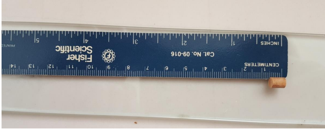
Şekil 3.9. Fraktometre ölçümü için hazırlanan 6 mm'lik örneğin görüntüsü
