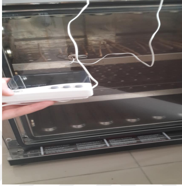
Şekil 3.7. İklimlendirme kabini içindeki sıcaklık ve bağıl nemin ölçülmesi
