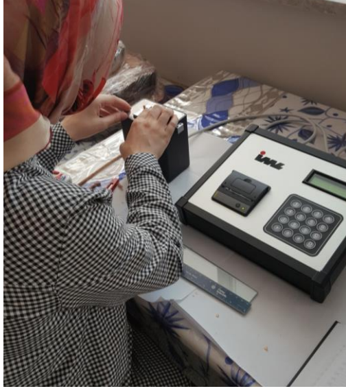
Şekil 3.11. Her 6 mm’de bir basınç direnci ölçümlerinin yapılması
