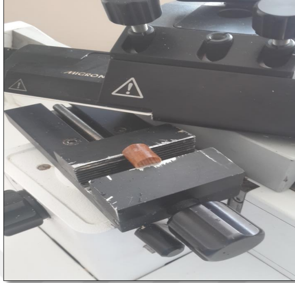
Şekil 3.19. Örneklerin mikrotoma yerleştirilmesi
