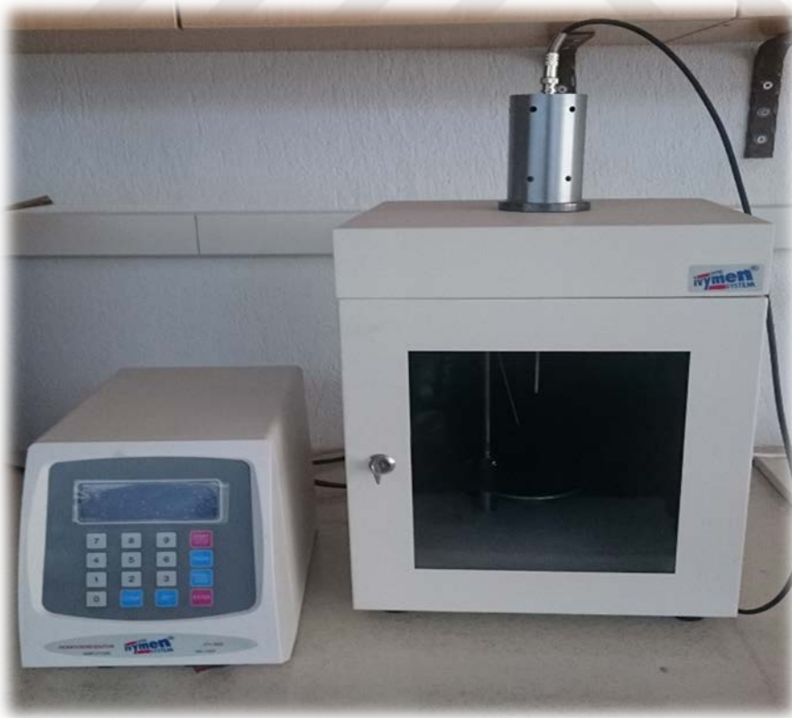
Şekil A. 7. Ultrases ekstraksiyonun gerçekleştirildiği Ultrases cihazı ve ultrasonik prob.
