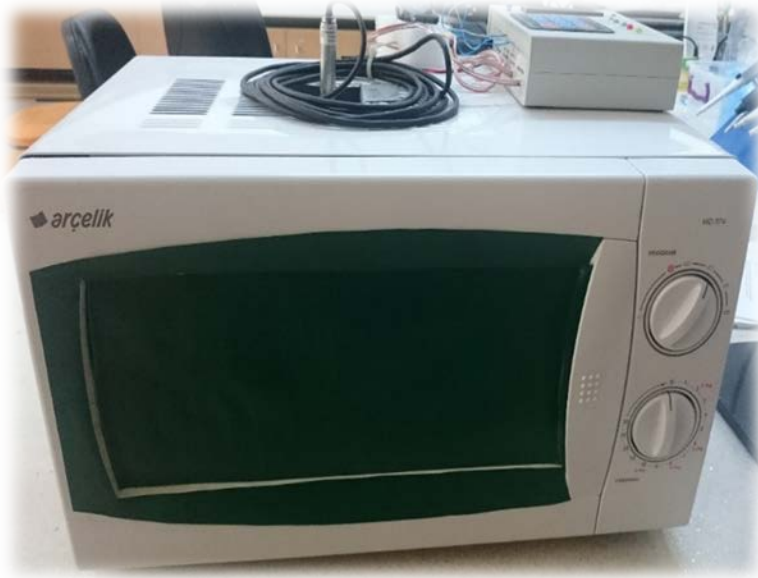
Şekil A. 2. Mikrodalga ekstraksiyonun gerçekleştirildiği modifiye edilmiş fırın.
