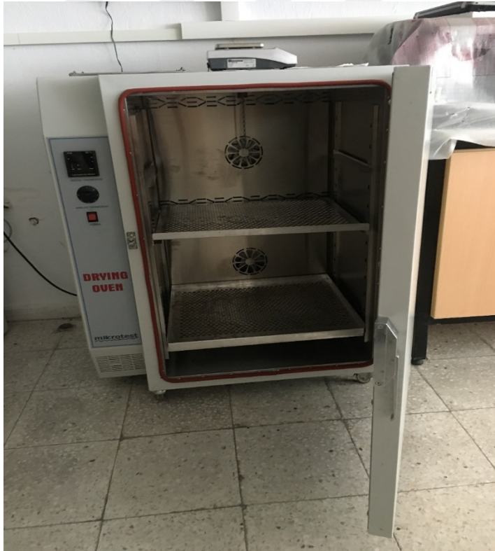
Şekil A. 5. Çalışmada hızlandırılmış raf ömrü analizinde ve kurutmada kullanılan fırın.
