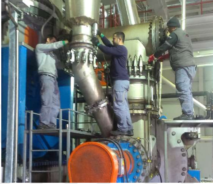
Şekil 3.3. Segment deęişimi için Rafinör'ün hazırlanma aşaması
