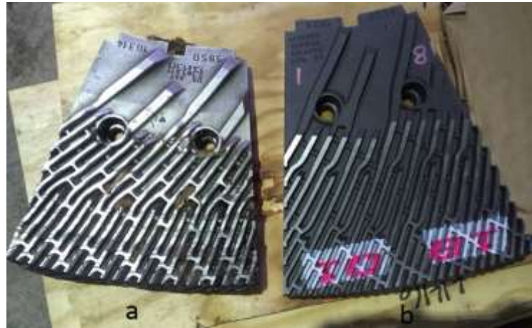
Şekil 3.5. Körelmiş segment örneği (a), kullanılmamış segment örneği (b)
