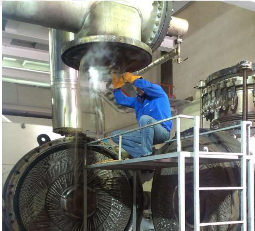
Şekil 1.11. Rafiner planlı bakım örneği
