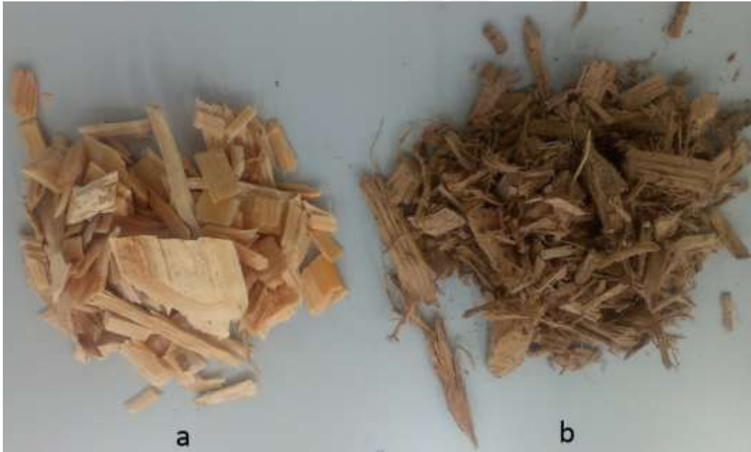
Şekil 3.1. (a) işlem görmemiş yongalar, (b) ön buharlama ve pişiricide işlem görmüş yongalar
