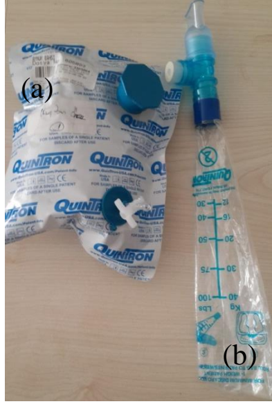
Şekil 4.14. OA-CEAS Lazer Spektroskopi için nefes toplama torbası (a) Analiz edilen havanın toplandığı kısım, (b) Atık torbası, ölü boşluk havasının toplandığı kısım
