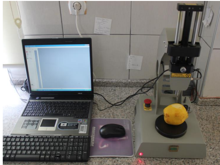
Şekil 3.10. Tekstür analiz cihazı ile meyve eti sertliği ölçümü
