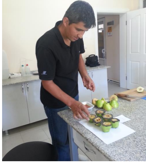
Şekil 3.9. Nişasta ölçümleri için meyvelerin İKİ çözeltisine batırılması
