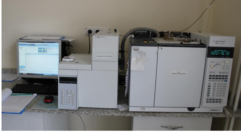
Şekil 3.14. Etilen üretimi ve solunum hızı ölçümleri yapılan gaz kromatografisi cihazı
