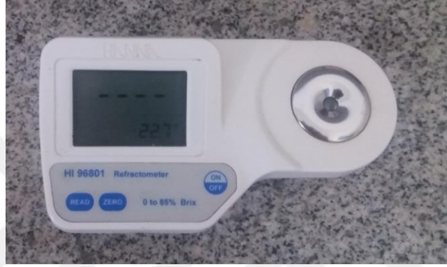
Şekil 3.11. Dijital refraktometre cihazı ile SÇKM ölçümü
