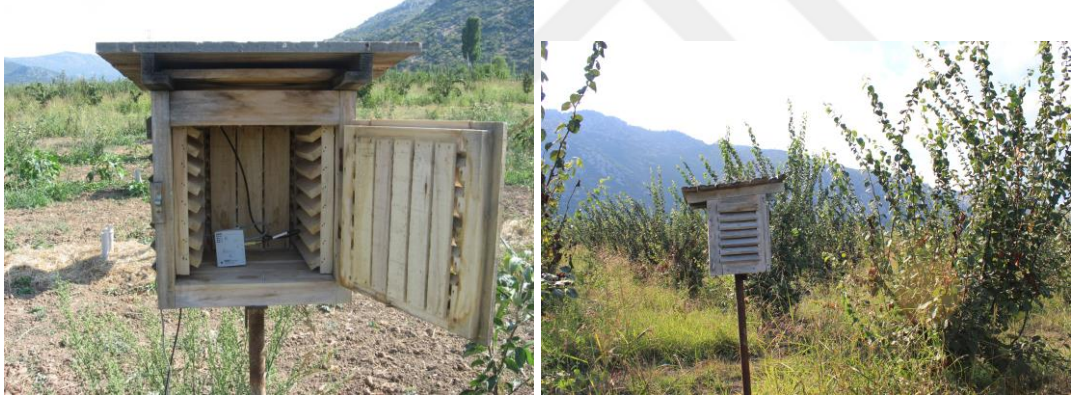
Şekil 3.5. Hava sıcaklığı ve nemi kaydeden HOBO cihazı ve muhafaza kabini
