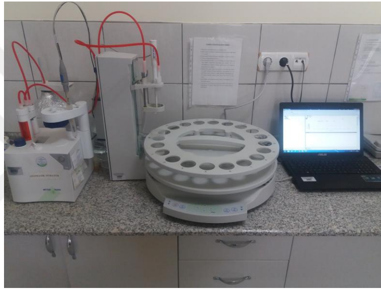
Şekil 3.12. Otomatik titratör cihazı ile meyve suyu pH'sı ve TEA ölçümü
