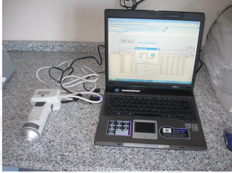
Şekil 3.13. Meyve kabuk rengi ölçümleri kullanılan renk ölçüm cihazı
