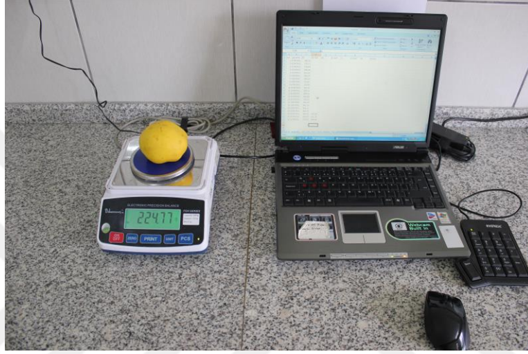
Şekil 3.8. Dijital terazi ile meyve ağırlıklarının ölçümü
