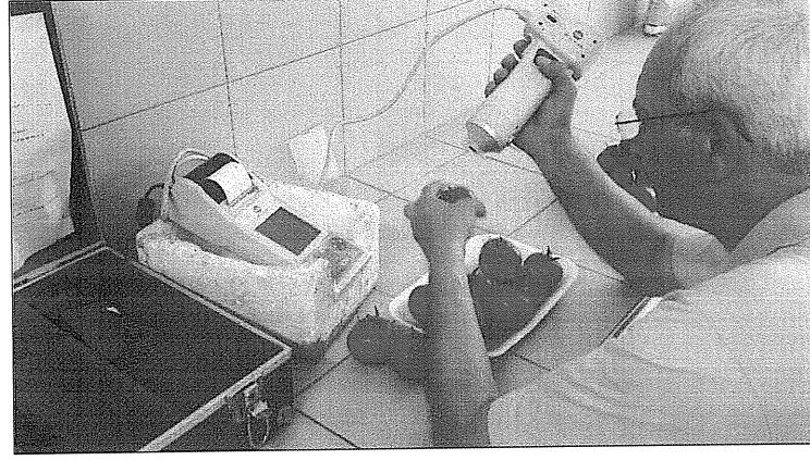
řekil 3.6. Minolta kolorimetresi ile yapılan renk lümleri
