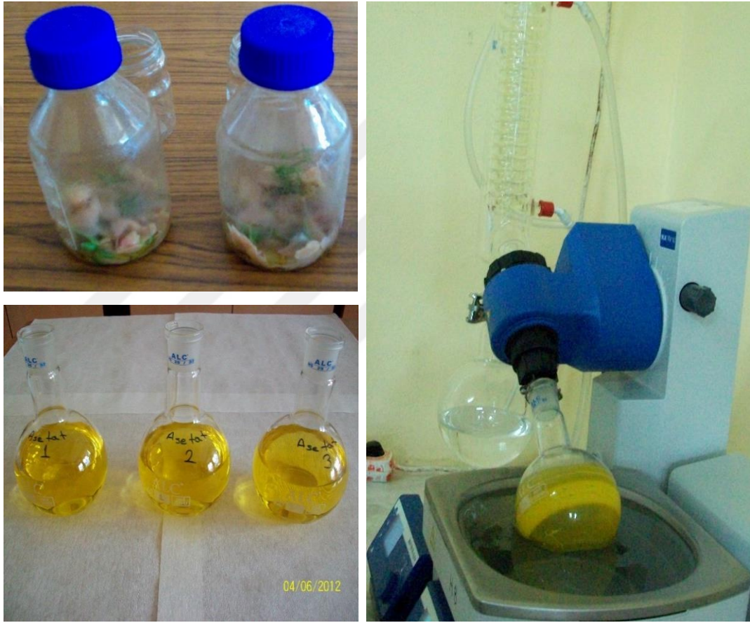
Şekil 3.1. Yağ gülü çiçeklerinden solvent ekstraksiyonu ile konkret elde edilmesi
