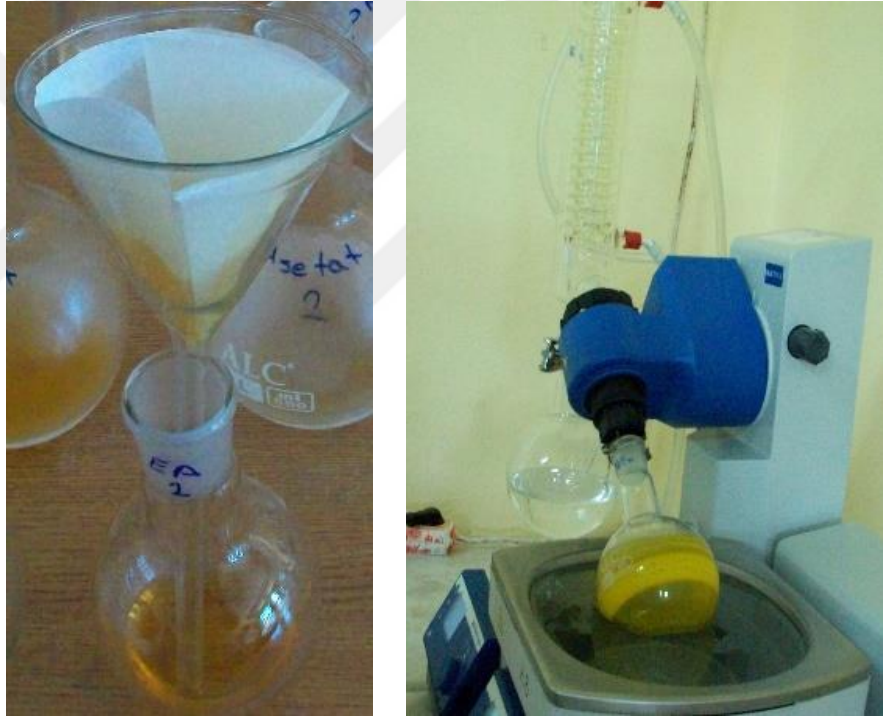
řekil 3.2. Yaę gülü çiçeklerinden elde edilen konkrattan etil alkol ekstraksiyonu ile absöüt elde edilmesi
