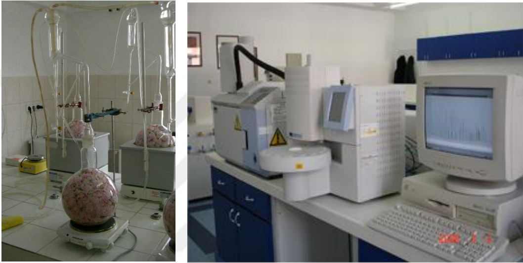
Şekil 3.3. Clevenger düzeneği ile yağ gülü çiçeklerinin damıtılması (solda) ve GC/MS cihazında uçucu yağ bileşenlerinin analizi (sağda)
