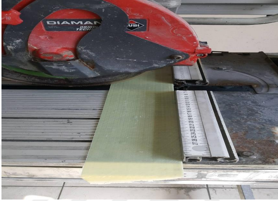
Şekil 3. 4. Rubi Diamant DS-300-1500 profesyonel kesme makinesi
