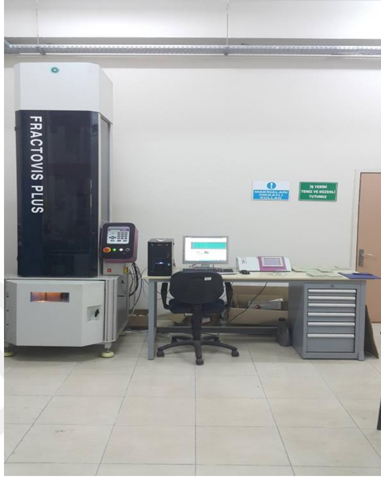
Şekil 3. 5. Fractovis Plus darbe cihazı
