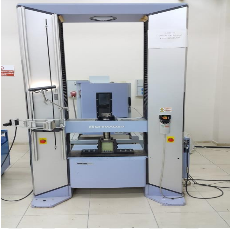
Şekil 3. 7. Shimadzu AG – X universal çekme basma test cihazı
