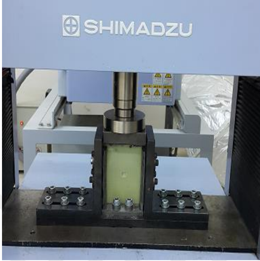
Şekil 3. 9. Basma cihazına bağlanan aparata yerleştirilen kompozit numune
