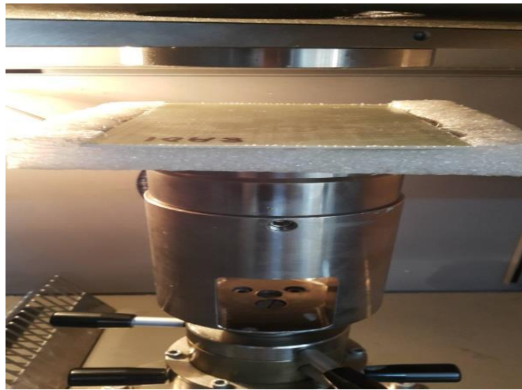
Şekil 3. 6. Kompozit numunelerin darbe test cihazına yerleştirilmesi
