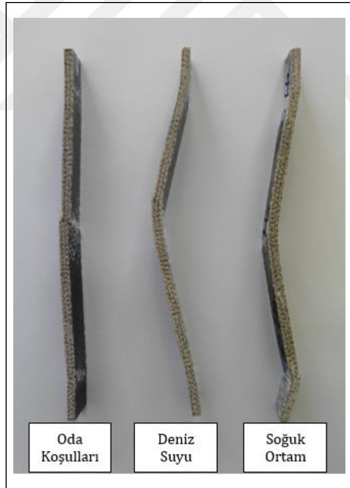
Şekil 4.45. Üç farklı ortam koşulu için H grubu hibrit kompozit numunelerinde meydana gelen deformasyonlar
