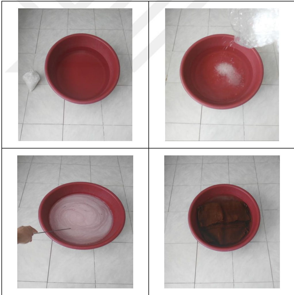
Şekil 3.3. Jüt kumaşların NaOH ile yüzey modifikasyon işlemi
