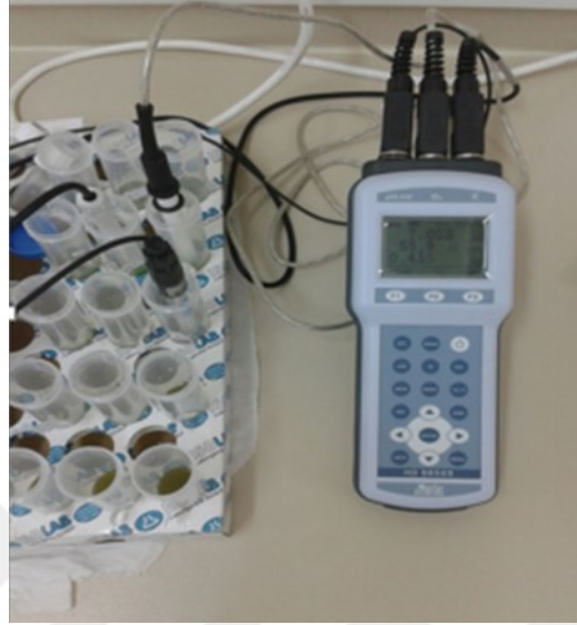
Şekil 3.10. pH, EC ve DO 2 için datalogger ve sensörler
