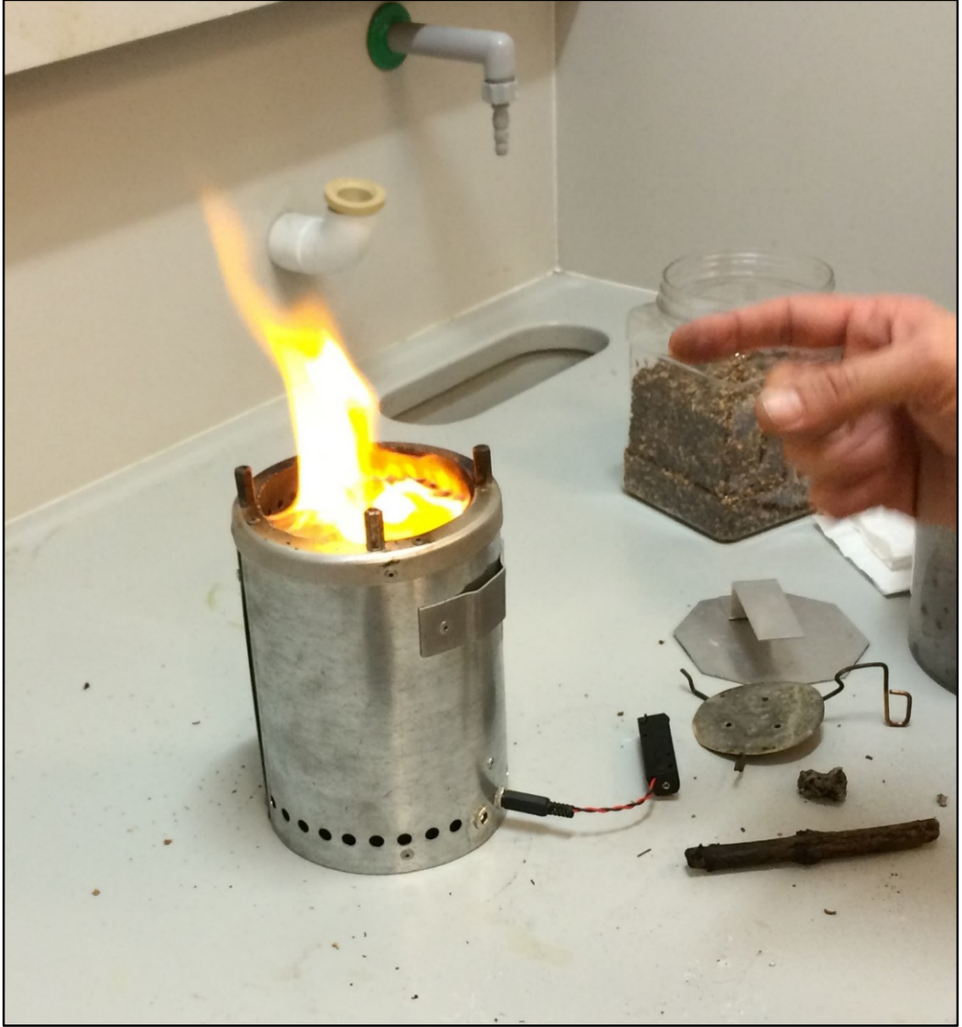
Şekil 3.3: Laboratuvar ortamında pirina yakıtı ile mini-gazlaştırıcı deneyi.
