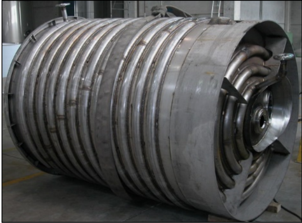
Şekil 3.12: Termal yağ kazanında bulunan serpantinler.
