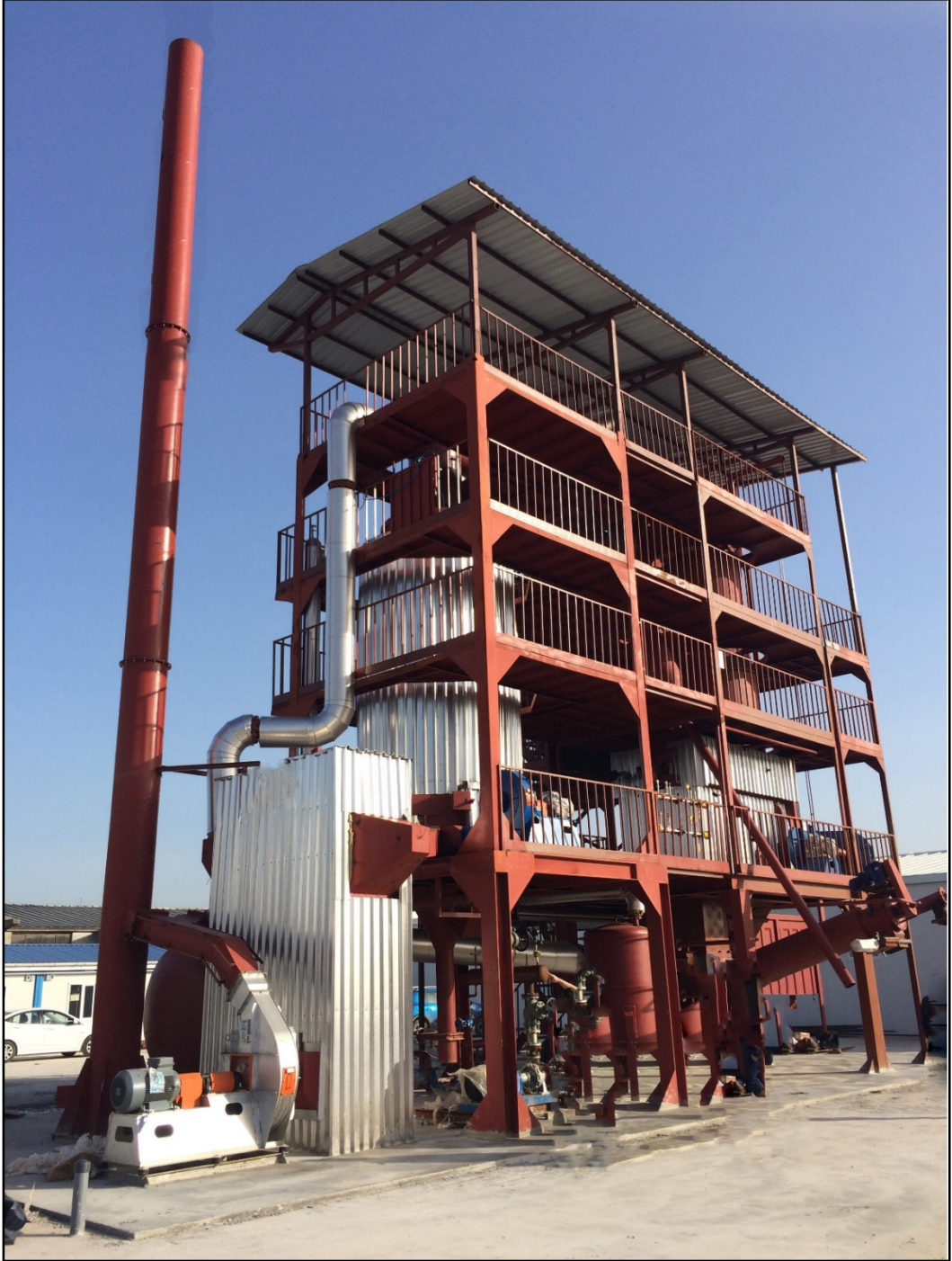
Şekil 3.6: Pilot ölçekli gazlaştırma sistemi yan görünümü.
