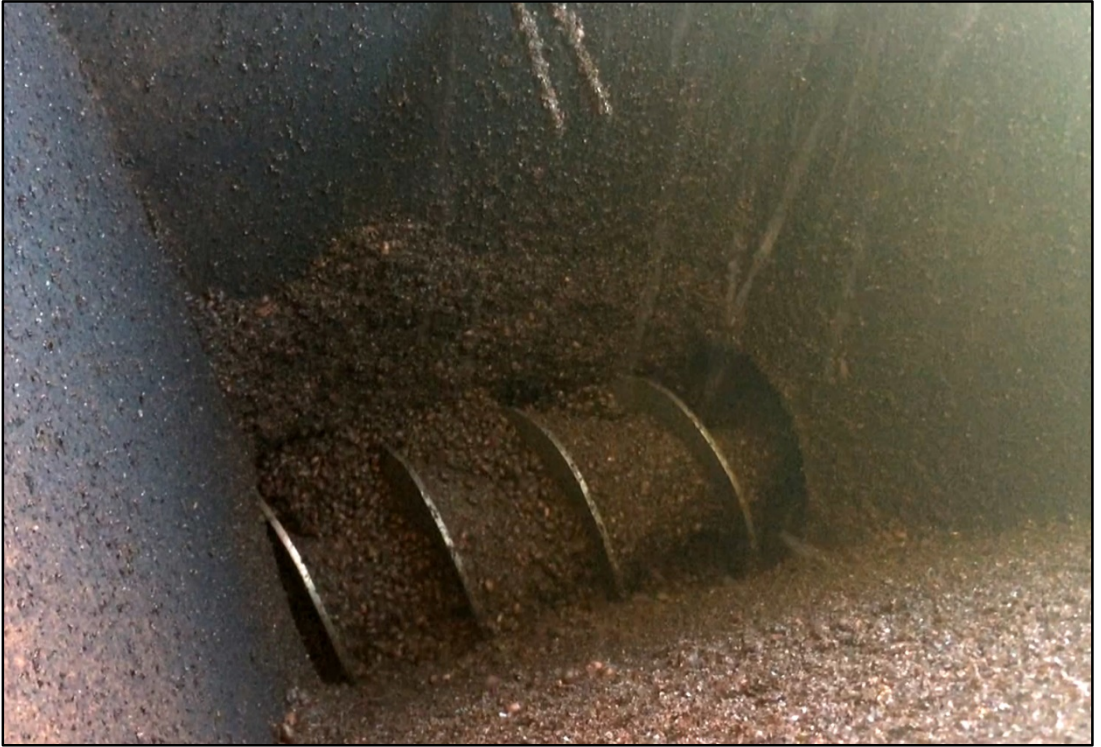
Şekil 3.9: Besleme sistemi günlük bunker.
