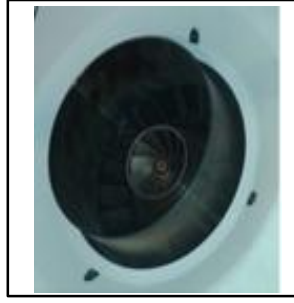
Şekil 2.5: Girdap şeklinde akış sağlayan helezon tip yakıcı.
