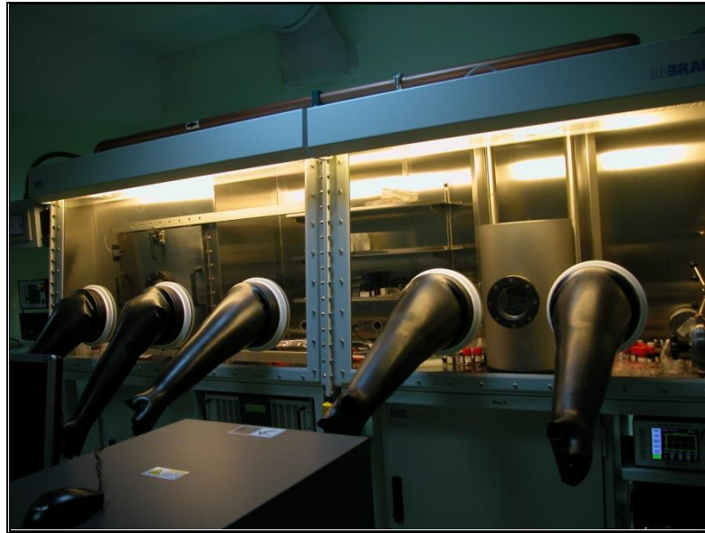
Şekil 3.3: OLED yapımında kullanılan eldivenli kutu.
