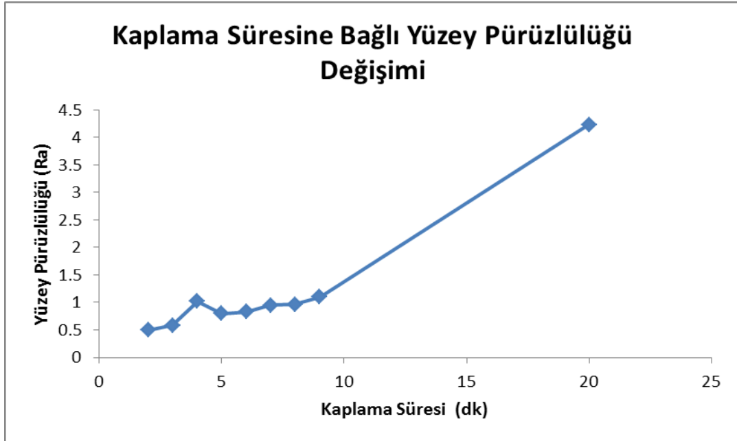
Şekil 6.2: Kaplama süresine bağı yüzey pürüzlülüğü değişimi.
