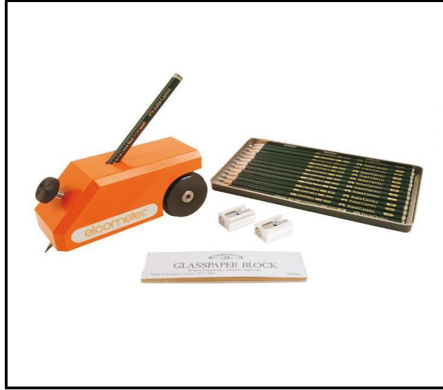
Şekil 5.3: Kalem sertliği test kiti.
