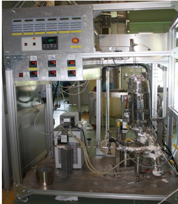
Şekil 4.13: Sabit yatak katalizör test sistemi.
