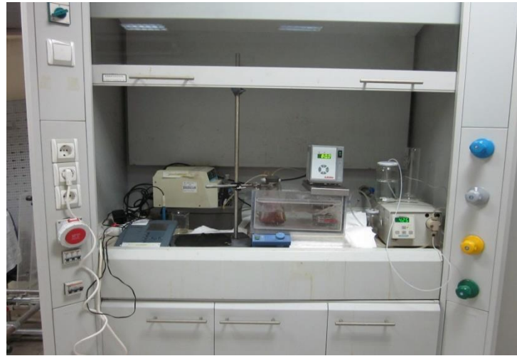
Şekil 4.2: Demir bazlı katalizör sentez düzeneği.
