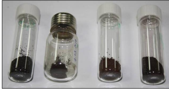
Şekil 4.4: Sentezlenen demir bazlı FT katalizör örnekleri.
