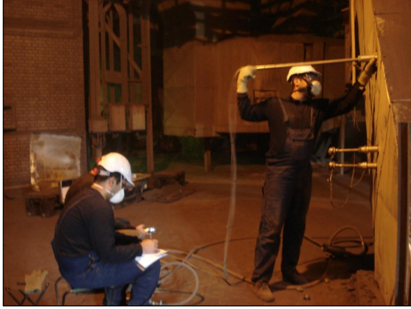
Şekil 4.2: Yakıcı kanalı hız ölçümü.
