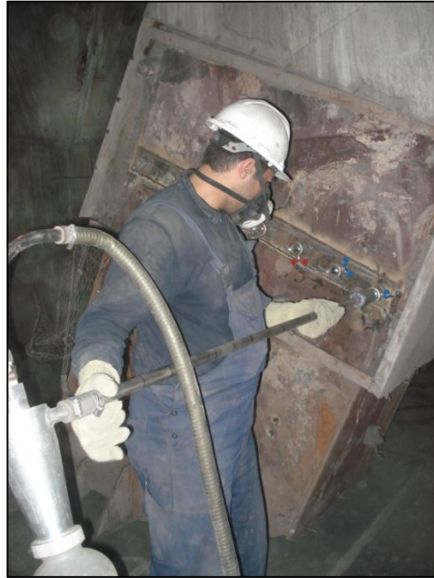
Şekil 4.3: Yakıcı kanalında eşkinetik kömür örnekleme ölçümü.
