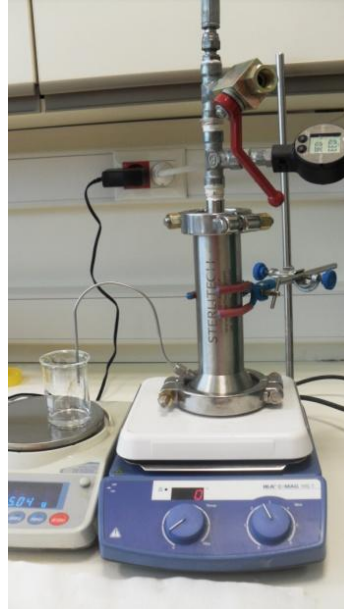
Şekil 3. 4: Laboratuvar ölçekli ölü uçlu membran filtrasyon sistemi.
