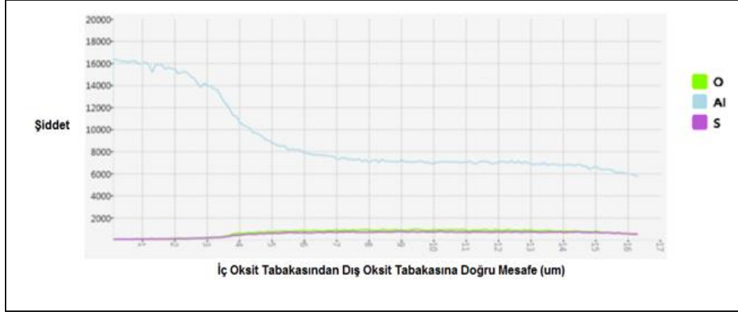
Şekil 6.31: DC üretim 16 V potansiyel uygulanmış levha kaplama boyunca element dağılım sonucu grafik gösterimi.
