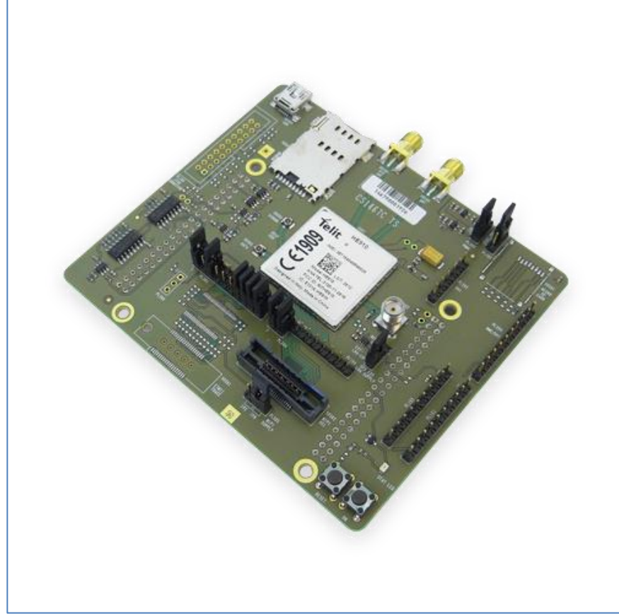
Şekil 4.2: Telit HE910 GPS/4G Modül.
