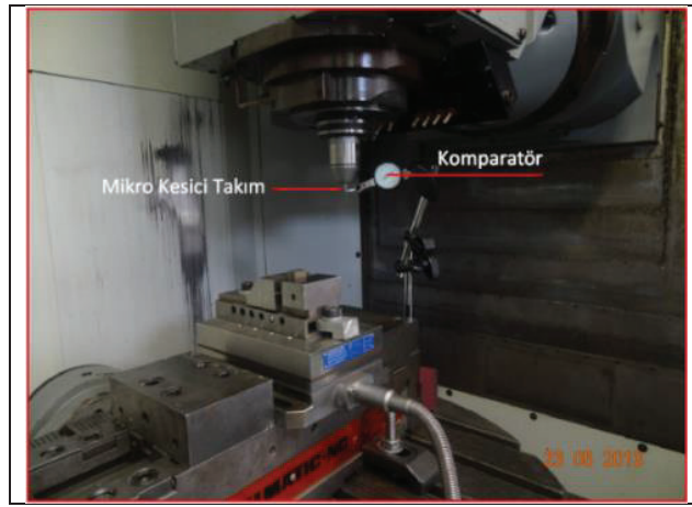
Şekil 3.5: Mikro kesici takımın salgısını ölçmek için komparatörün kurulumu.
