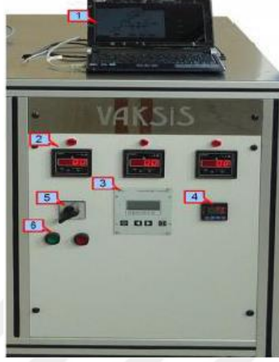
Şekil 2.9. 1) Kontrol bilgisayarı 2) Ampermetreler ve termal buharlaştırma güç kaynakları göstergesi 3) Turba pompa kontrol kısmı 4) Sıcaklık PID kontrol kısmı 5) Ana şalter 6) Aç/Kapa anahtarı (Ceylan, 2013)
