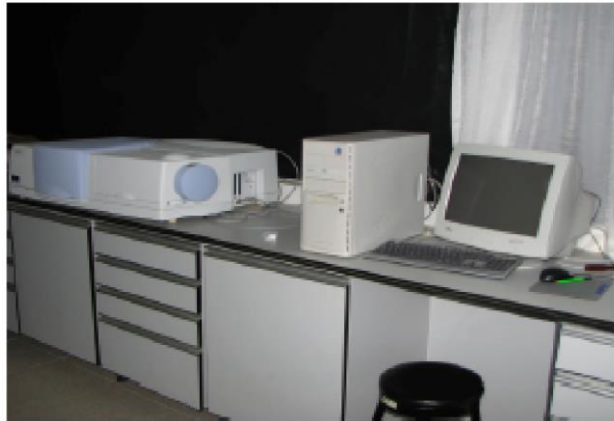
Şekil 3.5. Perkin Elmer Lambda 950 UV/VIS/NIR Spektrofotometre Sistemi
