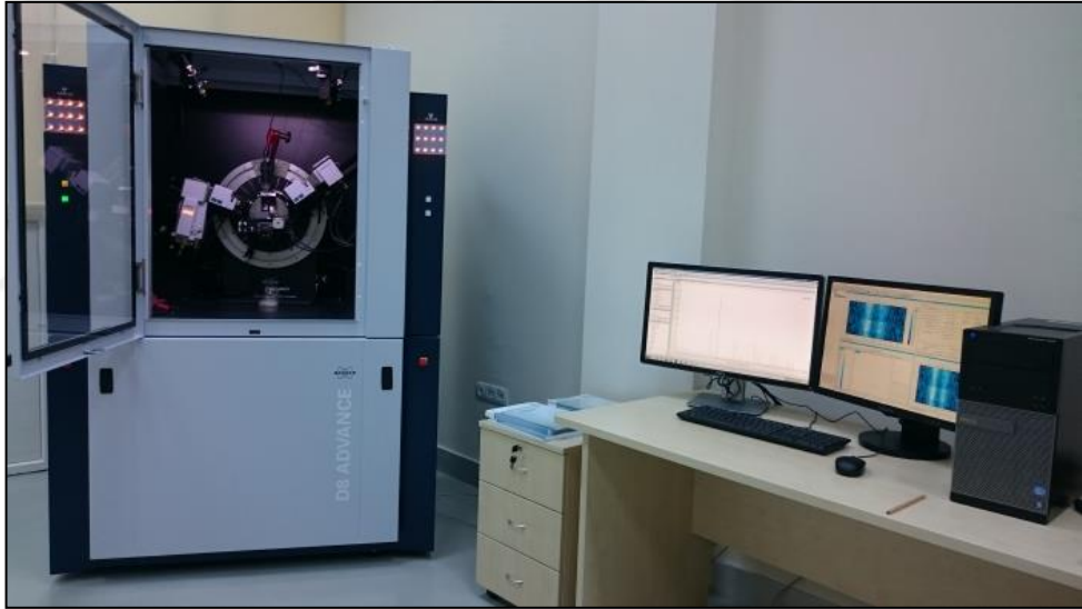
Şekil 3.2. Bruker D8 Advance Twin-Twin XRD cihazı (Kuş, 2017)
