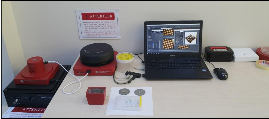
Şekil 3.4. Nanomagnetics ez-AFM Atomik Kuvvet Mikroskobu
