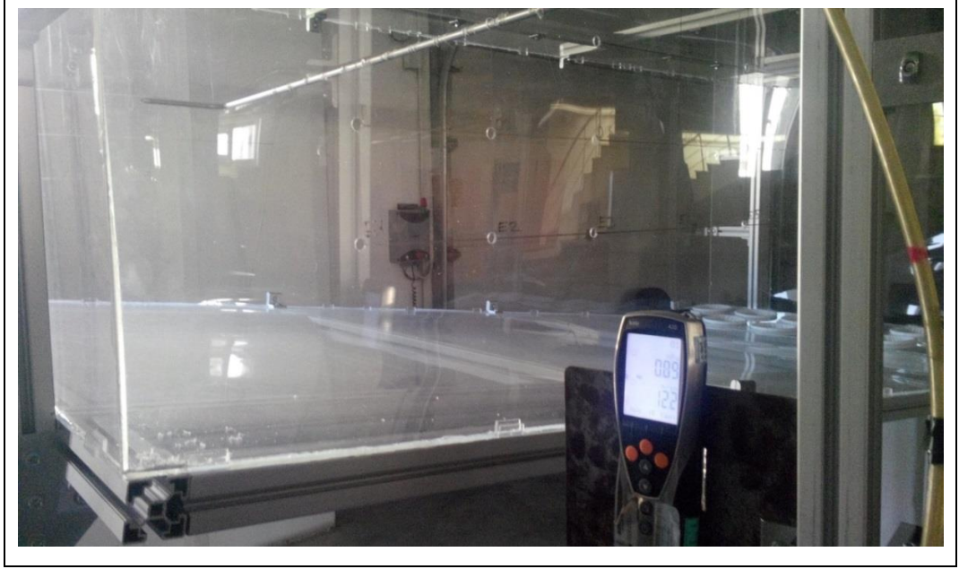
Şekil 3.8: Pitot tüpü ile aksenal hız ölçümü.
