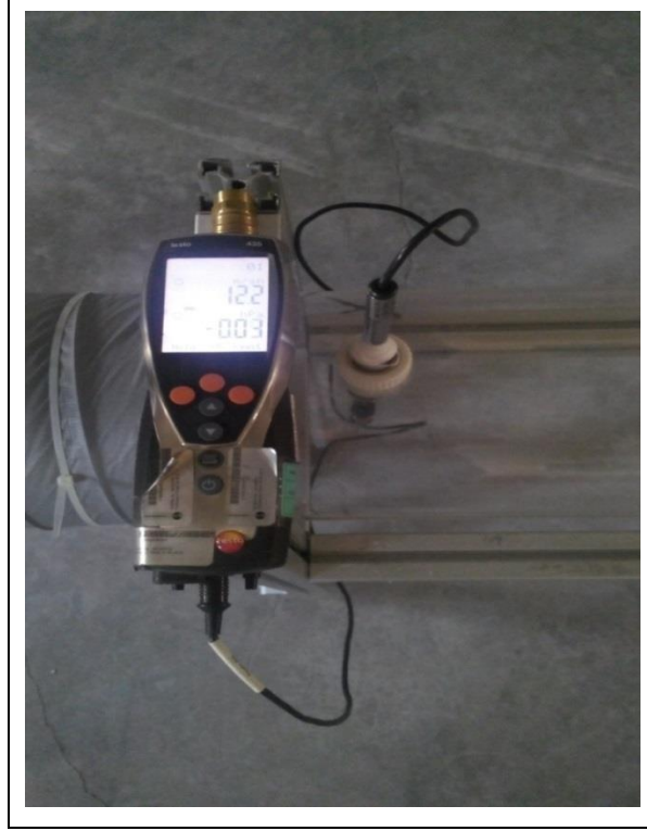
Şekil 3.7: Pervane tip anemometre ile kanal içi hız ölçümü.
