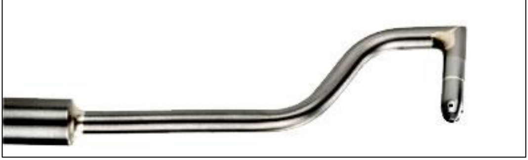
Şekil 3.9: Kobra başlı pitot tüpünün görünüşü.
