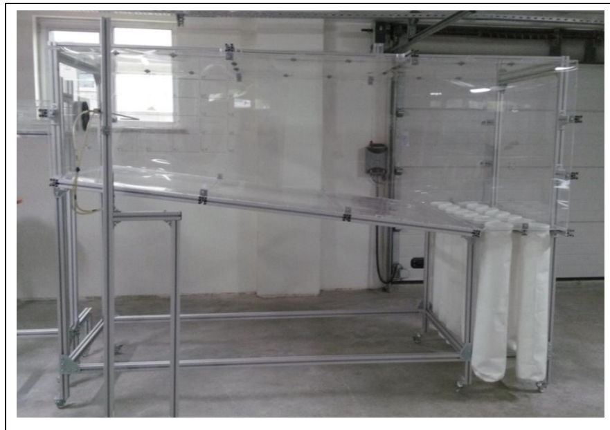
Şekil 3.2: Pleksiglas hazne ve alüminyum profil bağlantıları.
