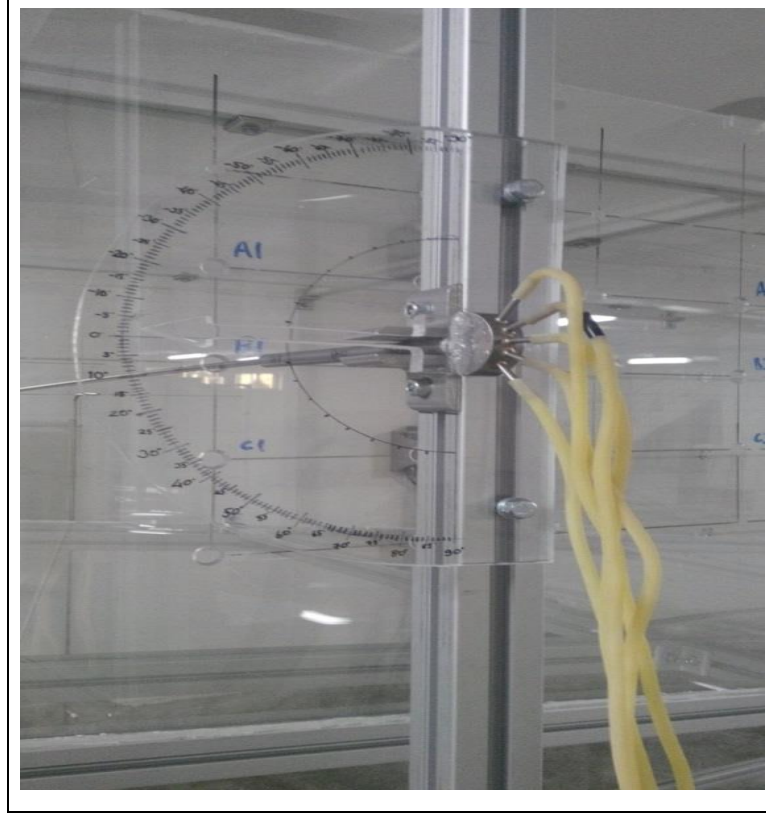
Şekil 3.12: Yalpalama açısı okuma gönyesi.
