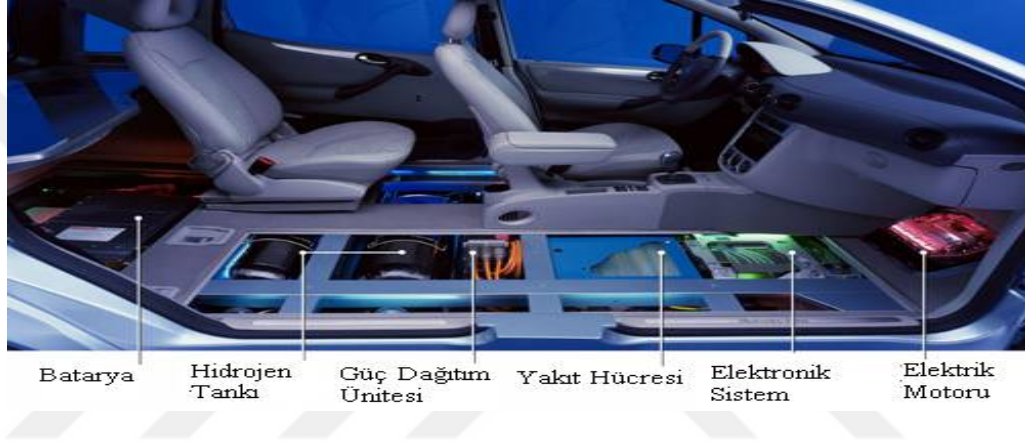
Şekil 2.10 Bir araç içerisinde yakıt pili sisteminin gösterilmesi
