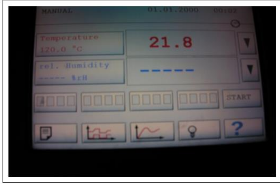
Şekil 7.2: Test cihazının kontrol ünitesi.
