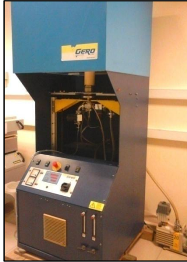
Őekil 6.3: İndirgeme ve sinterleme iřlemlerinin gerekleřtirildiėi dikey tip yksek sıcaklık vakum fırını.
