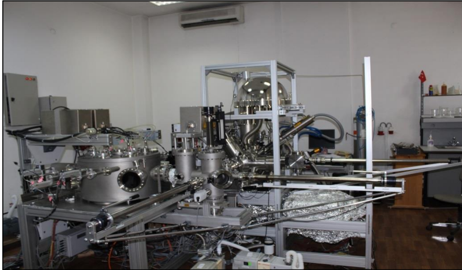
Şekil 6.1: GTÜ Nanoteknoloji Laboratuvarı Magnetron Sputtering Deposition sistemi.
