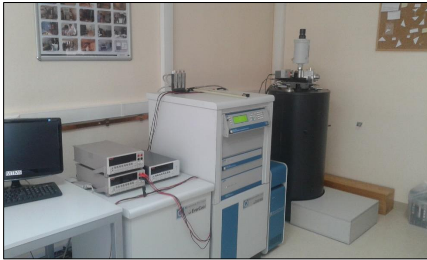
Şekil 6.18: GTÜ PPMS Laboratuvarı'nda kurulu bulunan VSM sistemi.
