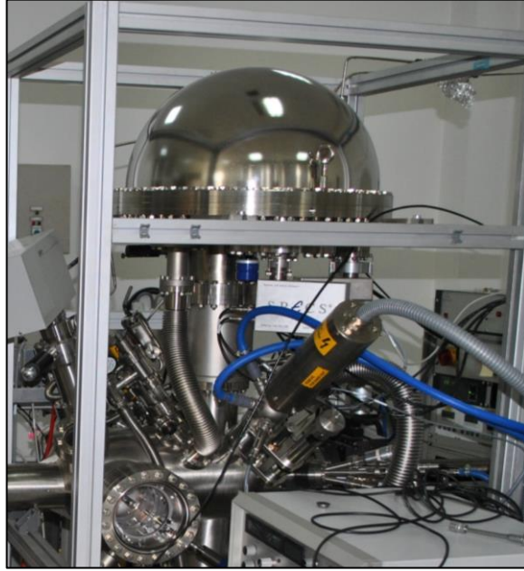
Şekil 6.4: GTÜ Nanoteknoloji Laboratuvarı XPS sistemi.
