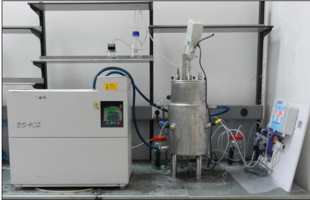
Şekil 3.1: Aklimizasyonun gerçekleştirildiği tam karışimli anaerobik reaktör.
