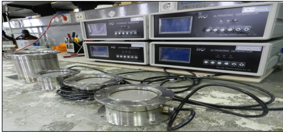
Şekil 3.2: Çalışmada kullanılan jeneratörler ve transdüserler.
